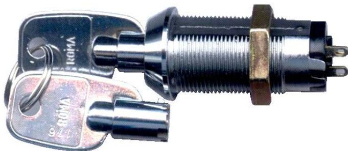
**ST-473** Chiave cilindrica con interruttore a due posizioni. Contatti C.NC.NA da 3 A isolamento 220 Volt. Fornita con due chiavi cilindriche antimpronta. Utile per abilitare e disabilitare qualsiasi apparecchiatura. Completa di 3 attacchi a saldare per il collegamento. Contenitore in metallo asola di orientamento. Dado di fissaggio. Dimensioni L43XØ19 mm. Peso 93 gr.
