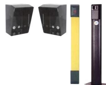
**SR-BOX** Coppia di **box** per fotocellule **SA-FL3**. Con tetto **parapioggia** spiovente. Indispensabili per proteggere le fotocellule da **urti accidentali** e da **facili asportazioni**. Corpo in lamiera acciaio spessore di 0,8 decimi, verniciato a fuoco con fori passacavo e di **fissaggio a parete o saldare**. Dimensione singola L60XH85XP.I.35XP.S.55 mm. € **27,00**
