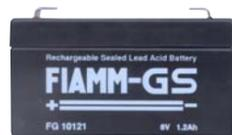
**SF-601** Batteria da *6 V. 1,2 Ah*. *Accumulatore in tampone*, ermetico a ricombinazione elettrolitica. Composta da piastre di piombo e soluzione solforosa, che per la reazione elettrolitica, si ha la *carica e la scarica*, sono racchiuse in *3 elementi da 2 V*. collegati in serie. Collegamenti esterni tramite *terminali polarizzati* tipo fasto maschi da 5 mm. Contenitore ABS. Forma parallelepipedo. Dimensioni L97XS25XH51 mm. #
