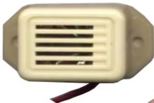
**SR-REM** Ronzatore piezoelettrico (Cicalino). Utile per segnalare il tempo di uscita e il tempo d'ingresso. Alimentazione 12 V. Assorbimento 10 mA. Contenitore in plastica con alette di fissaggio, distanza tra i fori 27 mm. Dimensioni L22XL16XH16 mm. € **3,00**
