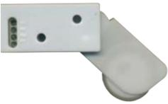
**SE-RCS** Rotello *rivelatore di rotazione* brevettato. Corrente massima di transito **1 A 250 V**. Campo di azione *infinito*, un impulso per ogni giro di ruota. Adatto per rivelare i movimenti di tapparelle, serrande, infisso scorrevole, installazione a parete con il *rotello snodabile* a molla che tocca contro una dogia della serranda. Contenitore plastico forma rettangolare snodabile. Dimensioni base L82XL22XS19 mm. € **27,00**
