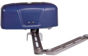
**SV-MSX** Motoriduttore elettromeccanico **A BRACCIO ARTICOLATO** con **SBLOCCO**. per cancelli ad ante fino a **2,5 metri** uso intensivo. Corpo in alluminio, coperchio plastico, con **sblocco** di emergenza a **chiave**. Non necessità di elettroserratura. Potenza 220 W. Protezione termica 135°. Angolo di apertura massima 120°. Dotato di staffe e bulloni per il fissaggio. **Alimentazione 220 V**. 50 Hz. Peso Kg 21,6. € **414,00**
