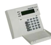
**SE-KPD** Tastiera remota per centrali ELKRON SE-KMT (MP110TGA). Tastiera supplementare da parete. Tasti in gomma retroilluminati. Collegamento con cavo SM-2S2 massimo 500 metri, su linea seriale. Segnalazione delle funzioni tramite display a 16 caratteri. Contenitore in ABS con Pulsante antistrappo. Dimensioni H110XL128XP26 mm. IMQ. € 155,00
