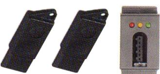
**SB-ICN** Inseritore per la **chiave elettronica (BPI3)** adatto a tutte le centrali **BENTEL**, assemblato su modulo della scatola 503. Tramite **3 led**; rosso, giallo, verde, segnala le funzioni in corso della centrale. Sulla centrale della serie norma, si possono installare un massimo di otto tra inseritori e tastiere SB-NTL. Collegamento bus parallelo, con cavo SM-2S4 massima lunghezza **400 metri**. Dimensioni H25XL43XP40 mm. #
