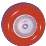
**ST-KC2** Badenia o **campana** a percussione per la segnalazione di **incendio**. Timpano in pressofusione di alluminio, verniciato a fuoco di **colore rosso**, forma tronco cono. Potenza sonora **93 dB**. Il colore e il tipo di suono sono caratteristiche vincolanti per distinguere un **allarme incendio** da altri allarmi. Installazione a parete. Alimentazione 24 V. Assorbimento 25 mA. Dimensioni Ø158XS55 mm. Peso Kg. 0,6. € 65,00
