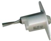
**SG-CMR** Contatto NC a sistema *magnetico* interno con *ruota pressata*. Corrente massima di transito **500 mA. a 100 V**. Adatto per controllare l'apertura di infissi ferrosi, porte blindate, casseforti aperture precarie. *Installazione a scomparsa*, fissaggio con viti laterali. Contenitore in plastica. Dimensioni installato L66XD24XDST20XDC6 mm. € **15,00**
