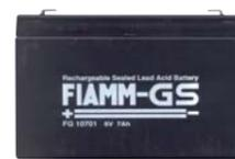
**SF-672** Batteria da 6 V. 7,2 Ah. Accumulatore in tampone, ermetico a ricombinazione elettrolitica. Composta da piastre di piombo e soluzione solforosa, che per la reazione elettrolitica, si ha la carica e la scarica, sono racchiuse in 3 elementi da 2 V. collegati in serie. Collegamenti esterni tramite terminali polarizzati tipo fasto maschi da 5 mm. Contenitore ABS. Forma parallelepipedo. Dimensioni L151XS34XH94 mm. # € 14,00
