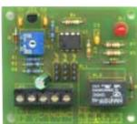
**SS-LBT** Circuito per il **controllo della batteria**. Controlla la soglia alta o bassa della batteria in tampone, **sensibilità regolabile** tramite trimmer. Jumper di programmazione per l'intervento del relè. Alimentazione 12 V. Relè 1 scambio 1 A 24 V. **Compatibile con qualsiasi tipo e marca di centrale di allarme**. Dimensioni L62XL52XH14 mm. € **19,00**
