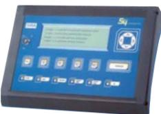
**SS-C54** Consolle; terminale remoto per la ripetizione eventi e comandi per centrale SS-A54. Lettura eventi su display, da 8 righe per 40 caratteri. Incorpora cicalino per la segnalazione degli eventi, disattivabile da tastiera. collegamento dalla centrale, tramite cavo SM-2S2 (non superiore a 1200 metri). Alimentazione da centrale, oppure tramite alimentatore locale 15 V. d.c. Installazione da tavolo o da muro. (MRS/232) # € 1.287,00
