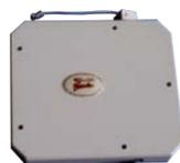
**SS-SAL** **Switchalarm** contatto meccanico NC. Il sistema è azionato da un **cordino in nylon** della lunghezza di **3 metri** circa. Avvolto e **scorre su carrucole**. Lo scorrere del cordino provoca **l'apertura del contatto per circa 50 mS**. (necessita dell'amplificatore conta impulsi SV-MSI). Adatto per **tapparelle e serrande**, le protegge: dal **taglio**, dallo **strappo** e dal **sollevamento**. Dimensioni L102XL90XS16 mm. € **8,00**
