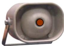
**ST-TLM** Sirena bitonale con diffusore esponenziale magnetodinamico alta resa. Pressione acustica 130 dB. Potenza 40 W. Utile come sirena di soccorso, per allarme esterno. Installazione dentro cassonetti di tapparelle, in altri luoghi protetti, in auto fissaggio tramite la staffa orientabile. Alimentazione 12 V. Assorbimento 1,5 A. Contenitore in plastica ABS. Dimensioni di ingombro L105XH80XP90 mm. Peso Kg. 0,700. € **40,00**
