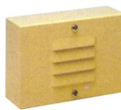
**ST-SBS** Sirena bitonale con diffusore esponenziale magnetodinamico. Circuito anti-manomissione tramite switch NC. Pressione acustica 105 dB. Potenza 10 W. Installazione a parete. Alimentazione 12 V. Assorbimento 1 A. Contenitore in scatola d'acciaio verniciata a fuoco. Asole a gelosia per diffusione sonora. Fissaggio a parete, tramite i fori interni. Dimensioni di ingombro L145XH95XP47 mm. Peso Kg. 0,900. € **40,00**
