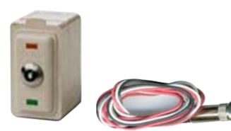
**SA-IMK** Inseritore in policarbonato su modulo TICINO MAGIC per chiavi SA-KBD. **Letto di codici** di sicurezza **sistema induttivo inglobato**. Elaborazione dati a **microprocessore**. **led verde, rosso** per segnalazione stato impianto. Collegamento altri inseritori in parallelo con **cinque fili** su morsetti polarizzati. Dimensioni L23XH43XP30 mm. € **28,00**
