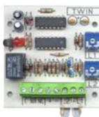
**SS-TWN** Modulo **amplificatore per sensori inerziali ST-IN4** e qualsiasi altro sensore che emette **impulsi veloci da 3 a 30 millisecondi**. Dispone di **due linee bilanciate**, con regolazione separata della sensibilità. Uscita relè 1 A 220V. Alimentazione 12 V. Analizza ed amplifica segnali veloci NA, supporta massimo 5 sensori, ad una distanza di 200 metri. Completo di basetta di fissaggio. Dimensioni L70XL55XH14 mm. € **17,00**
