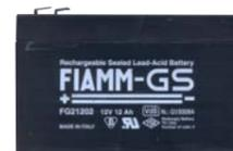
**SF-121** Batteria da 12 V. 12 Ah. Accumulatore in tampone, ermetico a ricombinazione elettrolitica. Composta da piastre di piombo e soluzione solforosa, che per la reazione elettrolitica, si ha la carica e la scarica, sono racchiuse in 6 elementi da 2 V. collegati in serie. Collegamenti esterni tramite terminali polarizzati tipo fasto maschi da 5 mm. Contenitore ABS. Forma parallelepipedo. Dimensioni L151XS98XH94 mm. # € 39,00
