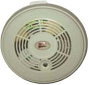
**ST-RFA** Rivelatore di fumo autonomo. Tecnologia a microprocessore. Incorpora suoneria da 96 Db. Segnalazione di batteria scarica. Alimentazione batteria alcalina 9 V (compresa). Assorbimento in riposo 0,3 µA. Installazione a soffitto, su un'altezza di 5 metri, può coprire un'area di due metri di raggio, indispensabile in cucina. Contenitore in ABS antiurto. Forma tronco cono. Dimensioni D125XS45 mm. Peso Kg 0,15. € 35,00
