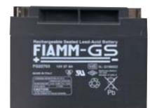
**SF-265** Batteria da 12 V. 65 Ah. Accumulatore in tampone, ermetico a ricombinazione elettrolitica. Composta da piastre di piombo e soluzione solforosa, che per la reazione elettrolitica, si ha la carica e la scarica, sono racchiuse in 6 elementi da 2 V. collegati in serie. Collegamenti esterni tramite terminali polarizzati tipo fasto maschi da 5 mm. Contenitore ABS. Forma parallelepipedo. Dimensioni L271XS166XH190 mm. # € 195,00
