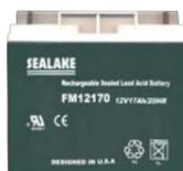
**SS-118** Batteria da **12 V. 18 Ah.** **Accumulatore in tampone**, ermetico a ricombinazione elettrolitica. Composta da piastre di piombo e soluzione solforosa, che per la reazione elettrolitica, si ha la **carica e la scarica**, sono racchiuse in **6 elementi da 2 V.** collegati in serie. Collegamenti esterni tramite **terminali polarizzati** tipo fasto maschi da 5 mm. Contenitore ABS. Forma parallelepipedo. Dimensioni L181XS76XH167 mm. € **46,50**
