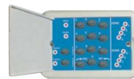
**SE-TPL** Tastiera per centrali serie SE-CGQ SE-CGO SE-COG. Le quali supportano massimo 4 tastiere. Le segnalazione sono a led, i quali sono una replica dei led della centrale. Accetta codice numerico a cinque cifre. Collegamento bus parallelo, con cavo SM-2S4 massimo 400 metri, su linea seriale. Dimensioni H73XL160XP25 mm.
