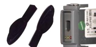
**SB-INM** Inseritore e **2 chiavi elettroniche** SB-DKC (oltre che per la centrale SB-BSD base - 2 nella quale si possono installare un massimo di 4 inseritori, è adatto a tutte le centrali BENTEL), assemblato su modulo della scatola 503. Tramite **3 led**; rosso, giallo, verde, segnala le funzioni della centrale. Collegamento bus parallelo, con cavo SM-2S4, massima lunghezza **400 metri**. Dimensioni H25XL43XP40 mm. #
