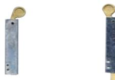
**SV-PAM PALETTO** blocco d'anta meccanico composto da un profilato d'acciaio zincato, con all'interno un perno d'ottone retrattile. Una robusta molla assicura il rientro del perno. Il dispositivo va fissato nell'anta femmina (quella che si chiude prima e che batte sul perno fissato in terra, dove è ricavato il foro per il perno di blocco). L'arrivo dell'anta maschio, schiaccia la rotula di ottone, la quale spinge il perno nel foro. € **48,00**
