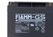
**SF-140** Batteria da 12 V. 40 Ah. Accumulatore in tampone, ermetico a ricombinazione elettrolitica. Composta da piastre di piombo e soluzione solforosa, che per la reazione elettrolitica, si ha la carica e la scarica, sono racchiuse in 6 elementi da 2 V. collegati in serie. Collegamenti esterni tramite terminali polarizzati tipo fasto maschi da 5 mm. Contenitore ABS. Forma parallelepipedo. Dimensioni L196XS163XH174 mm. # € 117,00
