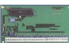
**SR-EB8** Modulo di *espansione 8 zone* per centrale ORBIT pro SR-COP. Ad ogni zona possono essere *assegnate 8 ripartizioni*. Le linee sono NC, NA, con resistenza e doppia resistenza di fine linea. Circuito con morsettiera di collegamento, con quattro fori angolari per il fissaggio. Dimensioni L105XH65XS16 mm. **IMQ** € **130,00**
