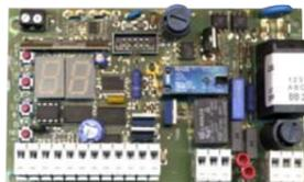
**SQ-36S** Centrale a **microprocessore** per cancello ad anta scorrevole. Le regolazioni per il comando del motoriduttore sono: tempo di lavoro apertura e chiusura, tempo di **apertura pedonale**, frizione elettronica e limitatore di coppia, rallentamento in apertura ed in chiusura. Le rimanenti caratteristiche sono identiche alla SQ-36B. Eccetto che comanda un solo motoriduttore e si installa nel suo interno. Alimentazione 220 V. 50 Hz. Dimensioni L275XH200XP110 mm. Peso Kg 1,43
