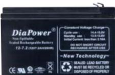
**SS-172** Batteria da **12 V. 7,2 Ah.** **Accumulatore in tampone**, ermetico a ricombinazione elettrolitica. Composta da piastre di piombo e soluzione solforosa, che per la reazione elettrolitica, si ha la **carica e la scarica**, sono racchiuse in **6 elementi da 2 V.** collegati in serie. Collegamenti esterni tramite **terminali polarizzati** tipo fasto maschi da 5 mm. Contenitore ABS. Forma parallelepipedo. Dimensioni L151XS65XH94 mm. € **13,70**
