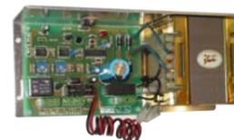
**SV-CBE** Carica batterie stabilizzato, alimentatore. **Ingresso 220 V. 50/60 Hz**, con fusibile di protezione. **Uscita 13,8 V cc. 2,2 A**. con fusibile. **Relè di allarme** per batteria scarica, tensione bassa, cortocircuito. **Montato su staffa** di alluminio a L. Adatto come carica batterie, per batterie ermetiche al Piombo. Utile come **ricambio per centrali di allarme** e alimentazioni supplementari. Dimensioni L200XH85XP68 mm. € **75,00**
