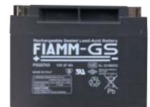
**SF-126** Batteria da 12 V. 26 Ah. Accumulatore in tampone, ermetico a ricombinazione elettrolitica. Composta da piastre di piombo e soluzione solforosa, che per la reazione elettrolitica, si ha la carica e la scarica, sono racchiuse in 6 elementi da 2 V. collegati in serie. Collegamenti esterni tramite terminali polarizzati tipo fasto maschi da 5 mm. Contenitore ABS. Forma parallelepipedo. Dimensioni L166XS175XH125 mm. # € 75,00
