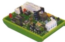
**SS-MR1** Modulo di linea aggiuntivo, gestisce 128 sensori indirizzabili. Il microprocessore viene gestito e programmato direttamente dalla centrale SS-A54, oppure tramite comunicazione seriale RS485. Funziona sia a circuito chiuso oppure aperto, possono essere collegati dispositivi indirizzati. Il modulo è in grado di funzionare senza l'aiuto della centrale. Alimentazione 27 V. Dimensioni L160XL95XS15 mm. # € 257,50
