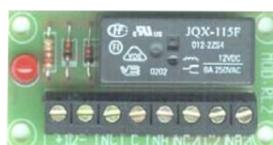
**SS-RL1** Circuito con **relè uno scambio**. Interfaccia per l'accoppiamento di circuiti o **centrali aventi uscita open collector**, sia negativa che positiva. Protetto contro inversione di polarità. Segnalazione tramite **led**. Alimentazione 12 V. Relè 1 scambio 1 A 24 V. **utile per qualsiasi applicazione e circuito elettronico**. Dimensioni L40XL36XH14 mm. € **11,00**
