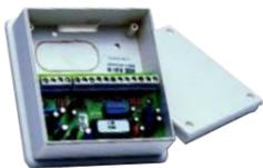
**SB-MIS** Modulo di espansione a **sei zone**, adatto per tutte le centrali espandibili BENTEL. SB-KYC e SB-KYT. Le caratteristiche delle zone le trovi sulla programmazione e configurazione della centrale. Collegamento alla centrale tramite bus a 4 conduttori. Il modulo si presenta in scatola di protezione in materiale plastico, con manomissione escludibile, e dipswitch per codifica indirizzo. Dimensioni L107XH101XP31 mm. € **63,00**
