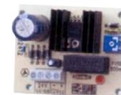
**SC-RTD** Riduttore di tensione in corrente continua da **24 V. a 12 V**. Fusibile di protezione ingresso 500 mA. Tensione massima di ingresso 24 V. Corrente **continua, oppure alternata**. Tensione di **uscita regolabile fino a 13 V**. Corrente massima erogabile, **120 mA. a 13 V**. Potenza massima dissipabile 1 W. Dimensioni L100XH80XS65 mm. € **28,00**
