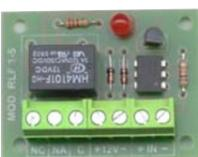
**SS-RLF** Circuito con **relè uno scambio**. Interfaccia di segnale basso, **fotoaccoppiato**, elimina disturbi e sovratensioni. Protetto contro inversione di polarità. Segnalazione tramite **led**. Alimentazione 12 V. **Relè 1 scambio 1 A 24 V. utile per qualsiasi applicazione elettronica dove necessita un alto isolamento**. Dimensioni L48XL36XH15 mm. € **15,00**
