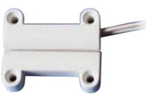
**ST-400** **Contatto magnetico** NC in ampolla di vetro sottovuoto. Corrente massima di transito **500 mA a 30 V**. **Campo magnetico 13 mm**. Conforme 1° livello CEI 79-2. Contenitore in **plastica** forma **rettangolare con fori di fissaggio**. Adatto per controllare l'apertura di infissi (non ferrosi). Dimensioni installato L32XH25XS8 mm. € **3,50**
