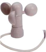
**SS-ANV** Anemometro sensore di **velocità del vento**. Da utilizzare con la centralina **SV-CAS**. Ogni giro di elica, un contatto, portata contatto 200 mA. a 100 V.dc. Cavo di collegamento con 2 conduttori da 2,5 mmq. lungo 4 metri. Contenitore PC UL94V-0 (IP54). Direttiva 89/336/CEE. Dimensioni imballo L240XH185XP110 mm. € **50,00**
