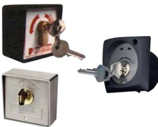
**SP-SC1** Selettore da **PARETE** o da **INCASSO** con due microswitch, comandati singolarmente dalla chiave, su tre posizioni. Posizione di centro spento, a destra apre, a sinistra chiude. Adatto per il comando manuale di: cancelli, serrande, Serratura italiana standard, con 2 chiavi. Contenitore in ABS. Dimensioni L71XH71XP45 mm. € **33,00**
