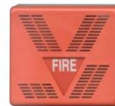
**SF-SIA** Sirena **piezoelettrica da interno**, con scritta lampeggiante **FIRE**. Modulazione elettronica con scelta di tre tipi di suono; **sirena, campana**, oppure **beep beep** di preallarme. Il colore e il tipo di suono sono caratteristiche, vincolanti per distinguere un allarme incendio da altri allarmi. Installazione a parete. Assorbimento 120 mA. Alimentazione 24 V. Contenitore ABS. Dimensioni L110XH100XP30 mm. Peso Kg. 0,45. € 41,00
