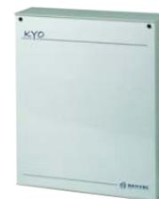
**SB-KYQ** Centrale a 4 zone (BENTEL KYO4M) chiamata telefonica multiprotocollo a bordo. Espandibile escluso le zone, con i moduli e tastiere serie KIO. Contenitore metallico. Alimentazione 220 V. CBE 12 V 1 A. Dimensioni L235XH296XP77 mm. € 139,00
