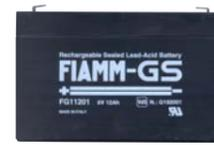
**SF-612** Batteria da 6 V. 12 Ah. Accumulatore in tampone, ermetico a ricombinazione elettrolitica. Composta da piastre di piombo e soluzione solforosa, che per la reazione elettrolitica, si ha la carica e la scarica, sono racchiuse in 3 elementi da 2 V. collegati in serie. Collegamenti esterni tramite terminali polarizzati tipo fasto maschi da 5 mm. Contenitore ABS. Forma parallelepipedo. Dimensioni L151XS50XH94 mm. # € 18,50
