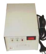
**SS-RL5** Stabilizzatore di tensione 220 V. 50/60 Hz, 500 W. Taglia tutti i picchi di corrente di ingresso da **170 a 240 V**. In uscita eroga una tensione **stabile di 220 V**. Completo di spina, presa e interruttore. **Segnalazione tramite tre led**, che indicano: **presenza di rete, alta, bassa**. Utile per apparati elettronici e centrali di allarme dove esistono **disturbi di rete**. Contenitore da tavolo. Dimensioni L200XL123XH90 mm. € **86,00**
