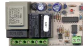
**SV-CT6** Centrale a *microprocessore* per motore delle *serrande* e tapparelle. Incorpora: *ricevente radio*, apprende i radiocomandi **433 MHz con codifica UM 86409**. tempi di lavoro e prestazioni in *autoapprendimento su memoria riscrivibile*. Un canale apre, un canale chiude. Alimentazione per fotocellule. Servizi: automatico, uomo presente. Alimentazione 220 V. Contenitore in ABS. Dimensioni L99XH50XS28 mm.
