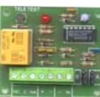
**SS-TSL** Circuito segnalatore di un **cambiamento di stato**, segnala con **impulsi differenziati, quando la tensione si presenta e quando scompare**. Jumper di programmazione impulsi differenziati. Alimentazione 12 V. Relè 1 scambio 1 A 24 V. Utile per comandare un **cicalino di impianto inserito e disinserto**. Dimensioni L63XL62XH14 mm. € **17,00**
