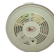
**SI-RFI** Rivelatore di fumo via radio. Frequenza 433 MHz. Codice variabile alta sicurezza, tecnologia a microprocessore. Incorpora suoneria da 96 Db. Segnalazione di batteria scarica. Compatibile con SI-LR5, SB-WD3, SV-RX4, SV-RX7, SV-RPU, SV-RP2. Alimentazione batteria alcalina 9 V. Per ampliamento protezione allarme incendio. Contenitore in ABS antiurto. Forma cilindrica. Dimensioni D125XS45 mm. € 80,00
