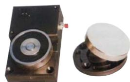
**SF-BE3** Elettromagnete **blocca porta** (per **porte tagliafuoco**), forza di trazione **30 kg**. Protetto **contro le sovratensioni**, e le inversioni di polarità. **Pulsante di sblocco**, con morsetti di collegamento. Completo di contropiastra, regolabile a 360°. Contenitore dell'elettromagnete in ABS nero. Installazione della base a parete, e la contropiastra fissata sulla porta. Alimentazione 24 V. Dimensioni L95XH60XP30 mm. € 54,00
