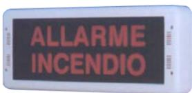
**SF-LMA** Lampada **monofaccia** ad **alta luminosità con segnalatore acustico**. Scritta **ALLARME INCENDIO**, posta su pannello in plexiglas **intercambiabile** di colore rosso. Installazione a parete, con le scritte ben visibili, indicanti le **vie di fuga**. Protetta contro l'inversione di polarità. Contenitore ABS bianco forma di parallelepipedo. Alimentazione 12/24 V. Assorbimento 30 mA. Dimensioni L306XH116XS61 mm. Peso Kg. 0,5. € 62,00
