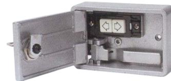
**SV-BEA** Blindino per comando esterno dell'elettrofreno SV-MSU. Con la maniglia adatta per la manovra manuale per lo *sgancio dell'elettrotreno*. Contiene un interruttore elettrico tipo TICINO MAGIC, utile per il comando sali scendi del motore. Corpo in *alluminio pressofuso*, sportello con cerniera interna completo di chiave di sicurezza. Installazione a parete o da incasso. Utile anche per la chiave elettronica SV-CE2 e simili. € **70,00**
