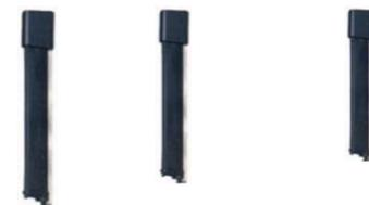
**SV-CPS** Costa meccanica montata su **profilato di alluminio**. **Sensore a microswitch**, azionato da un **cavo di acciaio tenuto in tensione**, la tensione è regolabile. Provvista di tappi, punti di fissaggio. Utile per la protezione **antischiacciamento** su automazioni. Supporto in gomma da 60 mm. Dimensioni L4,5XH1,700XP7,5 mm. € **53,00**
