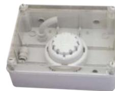
**SF-CAC** Camera di *analisi per condotte* di ventilazione e aspirazione. Incorpora *rivelatore di fumo* ad effetto Tyndall *convenzionale*. A richiesta può contenere qualsiasi rivelatore presente in questo listino. Completa di tubi, di diametro variabile richiesti per ottenere una *migliore campionatura*, dell'aria forzata prelevata dalle *condotte sotto protezione*. Contenitore ABS in scatola stagna con coperchio ispezionabile trasparente. Dimensioni L30XH25XP15 mm.
