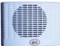
**SS-610** Sirena bitonale con un diffusore alta resa piezoelettrico. Pressione acustica 115 dB. Collegamento con morsetti polarizzati. Utile come deterrente di allarme interno. Come allarme su macchine operatrici. Fissaggio a parete, tramite i fori di fissaggio interni. Alimentazione 12 V. Assorbimento 200 mA. Contenitore in plastica con fori di fissaggio. Dimensioni di ingombro L101XH139XP40 mm. Peso Kg. 0,400. € **20,00**
