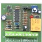
**SS-TIM** Circuito **temporizzatore universale**. Tempo regolabile tramite trimmer da **2" A 3 minuti**. Jumper di programmazione: per il **ritardo di eccitazione**, per l'**eccitazione momentanea o permanente**. Alimentazione 12 V. Relè 1 scambio 1 A 24 V. **Compatibile con qualsiasi tipo e marca di centrale di allarme**. Dimensioni L66XL61XH19 mm. € **22,00**
