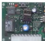
**SS-MRS** Modulo **radioricevente supereterodina** per centrale SS-PM8 e SS-PM5. Connessione ad innesto, su connettore a 10 poli. Apprende i radiocomandi **433 MHz con codifica UM 86409**. Uscita A relè contatto pulito **NA** da 0,5 A/24 Vac. Utile in ambienti disturbati da radiofrequenze e campi magnetici. Per una migliore ricezione installare l'antenna SV-TH4. Alimentazione 24 V. Dimensioni L55XH60XS18 mm.
