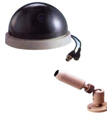
**SM-DCC** Dome camera **a colori**. Numero di pixel 512HX582V. 3,6 mm. **0,8 lux** F 1,2. Angolo di apertura **70°**. Sensibilità **1 lux**/F 1,2. Risol. **420 linee TV**. Contenitore base cilindrica, con cupola in materiale plastico trasparente. Dimensioni Ø75XH118 mm. Peso Kg. 0,100. Le rimanenti caratteristiche sono identiche alla SM-MCC.
