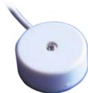
**ST-443** Sonda al *mercurio* adesiva, contatti NC immersi in una goccia di *mercurio in ampolla sottovuoto*. Le forti vibrazioni fanno saltare il mercurio, il quale libera i contatti. Corrente **500 mA. a 30 V**. Adatta per controllare vetrare, *proteggere dallo scasso strutture dure*. Contenitore troncocilindrico in plastica. Dimensioni D31XS15 mm. € **8,50**
