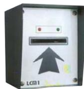
**SC-LCM** Lettore di carte magnetiche personalizzate. Riconosce e **memorizza 20 carte**. **Memoria non volatile**. Controllo funzioni con **due led e buzzer**. Alimentazione 12 V. **Tamper antistrappo**. Collegamento con **quattro fili max 200 metri**. uscita relé C.NC.NA. Contenitore in **acciaio trattato** e verniciato. Dimensioni L127XH76XP125 mm. € **397,00**
