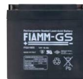
**SF-118** Batteria da 12 V. 18 Ah. Accumulatore in tampone, ermetico a ricombinazione elettrolitica. Composta da piastre di piombo e soluzione solforosa, che per la reazione elettrolitica, si ha la carica e la scarica, sono racchiuse in 6 elementi da 2 V. collegati in serie. Collegamenti esterni tramite terminali polarizzati tipo fasto maschi da 5 mm. Contenitore ABS. Forma parallelepipedo. Dimensioni L181XS76XH167 mm. # € 50,00
