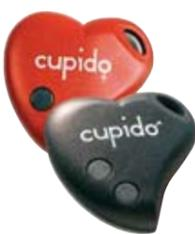
**SB-C2C** Radiocomando **BENINCÀ bicanale LUI e LEI**. Frequenza di trasmissione 433,92 MHz. Potenza trasmessa 1 mW. Trasmette 18 miliardi di combinazioni con il sistema di codifica **rolling code**. Segnalazione di trasmissione tramite **led**. Portata 60/100 metri. Riceventi consigliate SB-KRC SB-LR4. **Incorpora batteria**. Contenitore in materiale plastico formato portachiavi. Dimensioni L35XH60XS15 mm. € **36,00**
