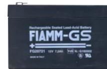
**SF-172** Batteria da 12 V. 7,2 Ah. Accumulatore in tampone, ermetico a ricombinazione elettrolitica. Composta da piastre di piombo e soluzione solforosa, che per la reazione elettrolitica, si ha la carica e la scarica, sono racchiuse in 6 elementi da 2 V. collegati in serie. Collegamenti esterni tramite terminali polarizzati tipo fasto maschi da 5 mm. Contenitore ABS. Forma parallelepipedo. Dimensioni L151XS65XH94 mm. # € 18,50
