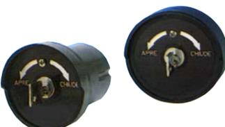
**SS-SC1** Selettore in plastica da **PARETE** con due microswitch, comandati singolarmente dalla chiave, su tre posizioni con ritorno a molla. Posizione di centro spento, a destra apre, a sinistra chiude. Adatto per il comando manuale di: cancelli, serrande, altro. Fissaggio a parete. Dotato di 2 chiavi. Dimensioni Ø75XH32 mm. € **25,00**
