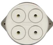
**ST-SB4** Sirena bitonale con quattro diffusori piezoelettrici. Pressione acustica 110 dB. Utile come deterrente di allarme interno. Come allarme su macchine operatrici. Fissaggio a parete, oppure sul pannello, tramite alette di fissaggio. Alimentazione 12 V. Assorbimento 160 mA. Contenitore in plastica con alette di fissaggio, distanza tra i fori 114 mm. Dimensioni di ingombro Ø100XH32 mm. Peso Kg. 0,170. € **19,00**
