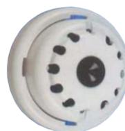
**SF-RFT** Rivelatore *doppia tecnologia convenzionale*, composto da un *rivelatore di fumo* ad effetto Tyndall, ed un *rivelatore di temperatura* con intervento a *62°*. Le rimanenti caratteristiche elettroniche, e fisiche sono identiche a SF-RFA. Utile nei luoghi con materiali infiammabili, che bruciano senza generare fumo.
