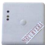
**ST-FGV** Microfono *rottura vetro ambientale*, rileva la frequenza della *rottura dei vetri* sia semplici che composti, analizza il segnale in ampiezza e in frequenza della velocità di ascesa e discesa del taglio del vetro. *Regolazione automatica della sensibilità*. Raggio di azione **20 metri**, *led memoria di allarme*. Uscita relè NC. Contenitore autoprotetto. Alimentazione 12 V. Assorbimento 30 mA. Dimensioni L76XH76XP19 mm. € **60,00**
