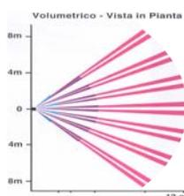
Diagramma di rilevazione con fissaggio a 2,1 metri dal pavimento. Il diagramma è visto dall'alto in orizzontale. La protezione volumetrica è 90 gradi dal centro sensore per una lunghezza di 15 metri, disposta su 4 zone.
