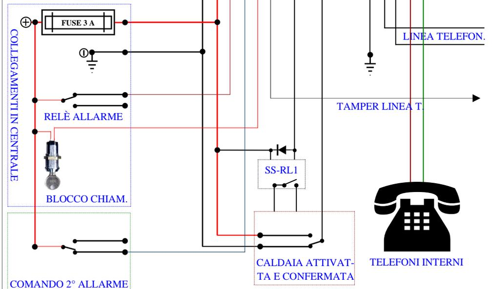
Schema di principio, l'importante che si utilizzino relè protetti della Securvera, la linea telefonica deve entrare prima nella chiamata poi ai telefoni.
