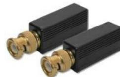
**SC-BAT** Trasmettitore e ricevitore di segnale **video composito**, su **cavo telefonico bipolare incrociato**. Impedenza di ingresso del trasmettitore 75 Ω. Impedenza di ingresso del ricevitore 100 Ω. Equalizzazione regolabile tramite potenziometro 0-30 dB. Distanza di funzionamento **600 metri** segnale **bianco e nero**, **400 metri** segnale a colori. Contenitore in ABS. Dimensioni L13XH18XP60 mm. Peso Kg. 1,2. € **142,00**
