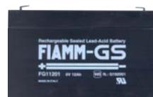
**SF-612** Batteria da **6 V. 12 Ah**. **Accumulatore in tampone**, ermetico a ricombinazione elettrolitica. Composta da piastre di piombo e soluzione solforosa, che per la reazione elettrolitica, si ha la **carica e la scarica**, sono racchiuse in **3 elementi da 2 V**. collegati in serie. Collegamenti esterni tramite **terminali polarizzati** tipo fasto maschi da 5 mm. Contenitore ABS. Forma parallelepipedo. Dimensioni L151XS50XH94 mm. € **28,00**
