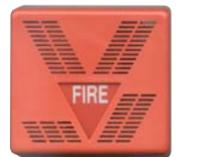
**SF-SIA** Sirena piezoelettrica da interno, con scritta lampeggiante FIRE. Modulazione elettronica con scelta di tre tipi di suono; sirena, campana, oppure beep beep di preallarme. Il colore e il tipo di suono sono caratteristiche, vincolanti per distinguere un allarme incendio da altri allarmi. Installazione a parete. Assorbimento **120 mA**. Alimentazione **24 V**. Contenitore ABS. Dimensioni **L110XH100XP30 mm**. Peso Kg. **0,45**. € **40,00**
