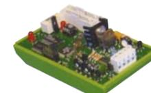
**SS-MR1** Modulo di **linea aggiuntivo**, gestisce **128 sensori indirizzabili**. Il microprocessore viene gestito e programmato direttamente dalla centrale SS-A54, oppure tramite comunicazione seriale RS485. Funziona sia a **circuito chiuso** oppure **aperto**, possono essere collegati dispositivi **indirizzati**. Il modulo è in grado di funzionare senza l'ausilio della centrale. Alimentazione 27 V. Dimensioni L160XL95XS15 mm.
