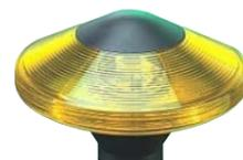
**SS-PUL** Lampeggiatore in metacrilato trasparente di **colore giallo**. Incorpora elettronica intermittente. Adatto come segnalatore di organi in movimento. Figura a **disco volante** anti pioggia. Installazione da **esterno a vista**, su colonna o palo. Contiene lampada 220 V 30 W. Alimentazione 220 V 50 Hz. Dimensioni Ø172XH110XB.Ø.50 mm. € **27,00**
