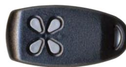
**SV-R2C** Radiocomando **bicanale**. Frequenza di trasmissione 433,92 MHz. Potenza trasmessa 1 mW. **Codifica con UM 86409** o emulatore, trasmette 4096 codici di sicurezza programmati dell'utente per mezzo di 10 dipswitch su due diversi canali. Segnalazione di trasmissione tramite **led**. Portata 60/100 metri. Incorpora batteria 12 V. Contenitore materiale plastico. Dimensioni L35XH60XS15 mm. € **20,00**
