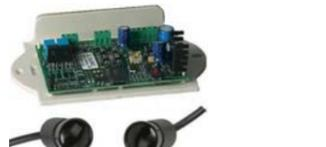
**SV-ADF** Coppia fotocellula. Composta da: amplificatore multiplexato elettronica ridondante, due sonde una trasmittente, una sonda ricevente. Allineamento e portata regolabile da 1 a 20 metri. Indispensabili per ascensori, bussole antirapina, passaggi controllati, porte automatiche. Tempo di intervento relè 50". Tempo di ripristino relè 0,5". Alimentazione 12/24 V. ac/dc. Dimensioni S110XH35XP75 mm. Peso 0,400 g. € **126,00**
