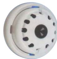
**SF-RFT** Rivelatore **doppia tecnologia convenzionale**, composto da un **rivelatore di fumo** ad effetto Tyndall, ed un **rivelatore di temperatura** con intervento a **62°**. Le rimanenti caratteristiche elettroniche, e fisiche sono identiche a SF-RFA. Utile nei luoghi con materiali infiammabili, che bruciano senza generare fumo. € **62,00**
