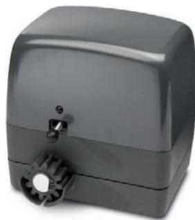
**SV-MRS** Motoriduttore elettromeccanico per cancello **SCORREVOLE 6 QUINTALI** Residenziale. Struttura in fusione d'alluminio, coperchio plastico, con **sblocco** a chiave. Giri motore 1400. Potenza 250 W. Protezione termica 140°. Peso massimo anta **600 Kg**. Completo di fincorsa apertura, chiusura. Condensatore 12,5 mF. Pignone per cremagliera universale. Completo di accessori per il fissaggio. **Alimentazione 220 V**. 50 Hz. Ricambio del Kit SV-KMS. Dimensioni H227XL230XP170 mm. Peso Kg 9
