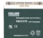
**SS-118** Batteria da **12 V. 18 Ah. Accumulatore in tampone**, ermetico a ricombinazione elettrolitica. Composta da piastre di piombo e soluzione solforosa, che per la reazione elettrolitica, si ha la **carica e la scarica**, sono racchiuse in **6 elementi da 2 V.** collegati in serie. Collegamenti esterni tramite **terminali polarizzati** tipo fasto maschi da 5 mm. Contenitore ABS. Forma parallelepipedo. Dimensioni L181XS76XH167 mm. € **62,00**
