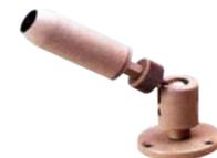
**SM-MCT** Minicamera **bianco e nero.** Numero di pixel 512HX582V. Risoluzione **380 linee TV.** Angolo di apertura **90°.** Assorbimento 100 mA. Completa di connettore di alimentazione e BNC su cavo. Contenitore cilindrico tubolare, in materiale plastico con staffa di fissaggio orientabile. Dimensioni L87XØ26 mm. Peso Kg. 0,100. Le rimanenti caratteristiche sono identiche alla SM-MBC. € **115,00**
