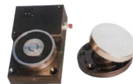
**SF-BE3** Elettromagnete blocca porta (per porte tagliafuoco), forza di trazione **30 kg**. Protetto contro le sovratensioni, e le inversioni di polarità. Pulsante di sblocco, con morsetti di collegamento. Completo di contropiastra, regolabile a **360°**. Contenitore dell'elettromagnete in ABS nero. Installazione della base a parete, e la contropiastra fissata sulla porta. Alimentazione **24 V**. Dimensioni **L95XH60XP30 mm**. € **50,00**
