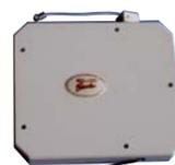
**SS-SAL** Switchallarm contatto meccanico NC. Il sistema è azionato da un **cordino in nylon** della lunghezza di **3 metri** circa. Avvolto e **scorrevole su carrucole**. Lo scorrere del cordino provoca **l'apertura del contatto per circa 50 mS**. (necessita dell'amplificatore conta impulsi SV-MSI). Adatto per **tapparelle e serrande**, le protegge: dal **taglio**, dallo **strappo** e dal **sollevamento**. Dimensioni L102XL90XS16 mm. € **8,00**
