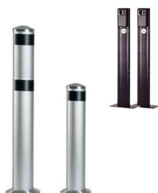
**SV-CFL** Coppia *paline* per fotocellule SV-LAP. Con tetto **parapioggia** in materiale plastico, ad incastro. Corpo in profilato di acciaio spessore di 0,8 decimi, verniciato a fuoco di colore nero. Indispensabili per l'installazione di fotocellule dove **non esistano pareti di appoggio**. Provvista di fori passacavo e base di **fissaggio a pavimento**. Dimensione della singola colonnina L60XH500XS35 mm. Peso 1.250 Kg. € **74,00**
