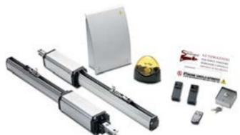
**SV-KBU** Kit automazione per cancello a 2 ante. Composto da: **2 motori** CON SBLOCCO a carrello. Corsa dei motori **300 mm**, per ante da **2 metri**. Apertura totale del cancello **4 metri**. **1** centrale SV-BUP con frizione elettronica, ricevente radio incorporata. **2** radiocomandi. **1** coppia di fotocellule SV-RF2. **1** lampeggiatore SV-LPF. **1** selettore a chiave SV-PLA con 2 chiavi. Cartello monitor. Istruzioni. Alimentazione **220 V**. 50 Hz. € **705,00**
