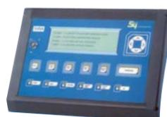
**SS-C54** Consolle; **terminale remoto** per la **ripetizione eventi e comandi** per centrale SS-A54. Lettura eventi su **display, da 8 righe per 40 caratteri**. Incorpora **cicalino** per la segnalazione degli eventi, **disattivabile da tastiera**. collegamento dalla centrale, tramite cavo SM-2S2 (non superiore a **1200 metri**). Alimentazione da centrale, oppure tramite alimentatore locale 15 V. d.c. Installazione da tavolo o da muro. (MRS/232)
