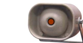
**ST-TLM** Sirena bitonale con **diffusore esponenziale magnetodinamico alta resa.** Pressione acustica **130 dB.** Potenza **40 W.** Utile come sirena di soccorso, per **allarme esterno.** Installazione dentro **cassonetti di tapparelle,** in altri luoghi protetti, **in auto fissaggio** tramite la staffa orientabile. Alimentazione 12 V. Assorbimento 1,5 A. Contenitore in plastica ABS. Dimensioni di ingombro L105XH80XP90 mm. Peso Kg. 0,700. € **30,00**
