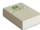
**SS-WA2** Rivelatore **presenza acqua**. Incorpora **cicalino piezoelettrico** avvertimento locale. Uscita relé di allarme, può **azionare idrovore e chiamata telefonica**. Utile per le perdite di acqua della lavatrice, sotto il lavello, per il bagno. Alimentazione **12 V**. Assorbimento **15 mA**. Contenitore in **plastica**. Dimensioni **127x40x26 mm**. € **80,00**
