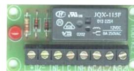
**SS-RL1** Circuito con *relè uno scambio*. Interfaccia per l'accoppiamento di circuiti o *centrali aventi uscita open collector*, sia negativa che positiva. Protetto contro inversione di polarità. Segnalazione tramite *led*. Alimentazione **12 V**. Relè **1 scambio 1 A 24 V**. utile per qualsiasi applicazione e circuito elettronico. Dimensioni **L40XL36XH14 mm**.
