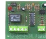
**SS-CLT** Circuito di controllo per la *manca di linea telefonica*. *L'assenza di linea oltre 10"* provoca *l'allarme*; *l'allarme può essere programmato momentaneo o perma- nente*. Alimentazione **12 V**. assorbimento **2 mA**. Relè **1 scambio 1 A 24 V**. *Compatibile con qualsiasi tipo e marca di centrale di allarme*. Dimensioni **L64XL52XH14 mm**.
