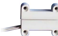
**ST-400** Contatto magnetico NC in ampolla di vetro sottovuoto. Corrente massima di transito **500 mA a 30 V**. **Campo magnetico 13 mm**. Conforme 1° livello CEI 79-2. Contenitore in **plastica** forma **rettangolare con fori di fissaggio**. Adatto per controllare l'apertura di infissi (non ferrosi). Dimensioni installato L32XH25XS8 mm. € **4,50**
