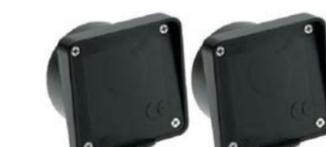
**SV-FTI** Coppia di *fotocellula autocentrante*, composta da trasmettitore e ricevitore. Portata direttiva **20 metri**. L'interruzione del raggio infrarosso, provoca la caduta dei due relè. Uscita relè **C.NC.NA.** da 1 A. a 30 V. **Installazione ad incasso**. Le rimanenti caratteristiche elettroniche, e fisiche sono identiche a SV-LAP. Dimensione singola L69XH69XP.Est.14X Dimensioni incasso Ø.Inter. 60XP.Incas. 32 mm. Peso 0,150 Kg. € **58,00**
