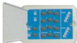
**SE-TPL** Tastiera per centrali serie **SE-CGO SE-CGO**. Le quali supportano **massimo 4 tastiere**. Le segnalazione sono a **led**, i quali sono una replica dei led della centrale. Accetta codice numerico a cinque cifre. Collegamento **bus parallelo**, con cavo SM-2S4 massimo **400 metri**, su linea seriale. Dimensioni H73XL160XP25 mm. € **67,00**
