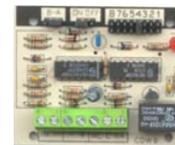
**SV-MSI** Circuito *contatore di impulsi NC*, impulsi elettrici, controlla la *continuità della linea*. Tramite Jumper si programma da **1 a 8 impulsi molto brevi** l'intervento del relè. Utilità: *analisi dello switchallarm SS-SAL*, nonché di qualsiasi altro sensore, che entro *otto minuti deve emettere almeno 2 impulsi per generare un allarme*. Alimentazione **12 V**. Uscita relè **1 scambio 1 A 24 V**. Dimensioni **L70XL55XH14 mm**.
