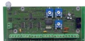
**SM-CA2** Scheda logica di: **analisi, programmi, segnalazioni e tempi**; contiene **due zone**. Circuito completo di morsettiere di collegamento. **Jumper, tamper** con molla. Utile come parte di ricambio della centrale **SM-CL1**. Dimensioni L141XH65XS18 mm. € **46,00**
