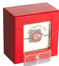
**SS-PRL** Pulsante manuale ripristinabile; attiva e memorizza l'allarme. Coperchio di protezione trasparente. Qualora si verifichi un incendio, per dare l'allarme premere sul coperchio di protezione, installazione consigliata in lungo accessibile e ben visibile. Collegamento due o tre fili. Contenitore in plastica rossa, in forma di parallelepipedo, con fessura per il ripristino del pulsante di allarme. Grado di protezione **IP54**. Dimensioni **L90XH90XP5 mm**. Peso Kg. **0,18**. € **105,00**
