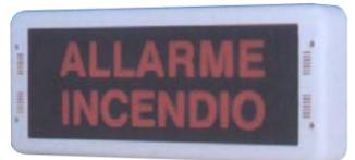
**SF-LMA** Lampada monofaccia ad alta luminosità con segnalatore acustico. Scritta ALLARME INCENDIO, posta su pannello in plexiglas intercambiabile di colore rosso. Installazione a parete, con le scritte ben visibili, indicanti le vie di fuga. Protetta contro l'inversione di polarità. Contenitore ABS bianco forma di parallelepipedo. Alimentazione **12-/24 V**. Assorbimento **30 mA**. Dimensioni **L306XH116XS61 mm**. Peso Kg. **0,5**. € **62,00**
