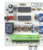
**SS-TWN** Modulo *amplificatore* per *sensori inerziali ST-IN4* e qualsiasi altro sensore che emette *impulsi veloci da 3 a 30 millisecondi*. Dispone di *due linee bilanciate*, con regolazione separata della sensibilità. Uscita relè **1 A 220V**. Alimentazione **12 V**. Ana- lizza ed amplifica segnali veloci **NA**, supporta massimo **5 sensori**, ad una distanza di **200 metri**. Completo di basetta di fissaggio. Dimensioni **L70XL55XH14 mm**.
