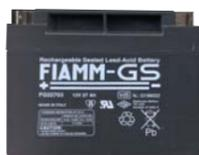
**SF-126** Batteria da **12 V. 26 Ah. Accumulatore in tampone**, ermetico a ricombinazione elettrolitica. Composta da piastre di piombo e soluzione solforosa, che per la reazione elettrolitica, si ha la **carica e la scarica**, sono racchiuse in **6 elementi da 2 V.** collegati in serie. Collegamenti esterni tramite **terminali polarizzati** tipo fasto maschi da 5 mm. Contenitore ABS. Forma parallelepipedo. Dimensioni L166XS175XH125 mm. € **117,00**
