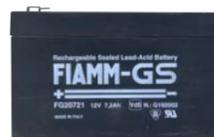
**SF-172** Batteria da **12 V. 7,2 Ah. Accumulatore in tampone**, ermetico a ricombinazione elettrolitica. Composta da piastre di piombo e soluzione solforosa, che per la reazione elettrolitica, si ha la **carica e la scarica**, sono racchiuse in **6 elementi da 2 V.** collegati in serie. Collegamenti esterni tramite **terminali polarizzati** tipo fasto maschi da 5 mm. Contenitore ABS. Forma parallelepipedo. Dimensioni L151XS65XH94 mm. € **29,00**
