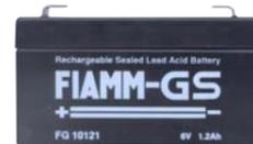
**SF-601** Batteria da **6 V. 1,2 Ah**. **Accumulatore in tampone**, ermetico a ricombinazione elettrolitica. Composta da piastre di piombo e soluzione solforosa, che per la reazione elettrolitica, si ha la **carica e la scarica**, sono racchiuse in **3 elementi da 2 V**. collegati in serie. Collegamenti esterni tramite **terminali polarizzati** tipo fasto maschi da 5 mm. Contenitore ABS. Forma parallelepipedo. Dimensioni L97XS25XH51 mm. € **11,00**
