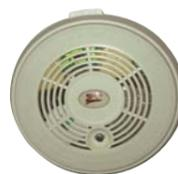
**ST-RFA** Rivelatore di **fumo autonomo**. Tecnologia a microprocessore. **Incorpora sonda** da **96 Db**. Segnalazione di batteria scarica. **Alimentazione batteria** alcalina 9 V (compresa). Assorbimento in riposo **0,3 µA**. Installazione a soffitto, su un'altezza di **5 metri**, può coprire un'area di **due metri di raggio**, indispensabile in cucina. Contenitore in ABS antiurto. Forma tronco cono. Dimensioni D125XS45 mm. Peso Kg 0,15.
