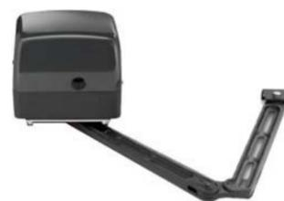
**SV-MXA** Motoriduttore **elettromeccanico A BRACCIO ARTICOLATO** con **SBLOCCO**. Per anta singola da **2,5 mt**. Oppure come ricambio del Kit SV-KXM. Corpo in alluminio, coperchio plastico, con **sblocco a chiave**. Non necessità di elettroserratura. Potenza **200 W**. Protezione termica **135°**. Angolo di apertura massima **120°**. Dotato di staffe e bulloni. **Alimentazione 220 V. 50 Hz**. Dimensioni H225XL230XP170 mm. Peso Kg 8 € **360,00**
