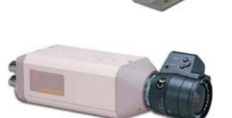
**SM-TEC** Telecamera a **colori**. Risoluzione **420 linee TV**. Ottica **6 mm/F2.0**. Definizione ottimale immagini **25 metri**. Infrarosso da **24 led**, Ass.1,5 A. Contenitore stagno **IP66**. Dimensioni Ø80XL130 mm. Le rimanenti caratteristiche sono come SM-TCC. € **245,00**
