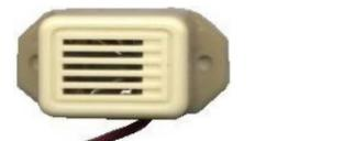
**SR-REM** Ronzatore piezoelettrico (Cicalino). Utile per segnalare il **tempo di uscita e il tempo d'ingresso.** Alimentazione 12 V. Assorbimento 10 mA. Contenitore in plastica con alette di fissaggio, distanza tra i fori 27 mm. Dimensioni L22XL16XH16 mm. € **5,00**
