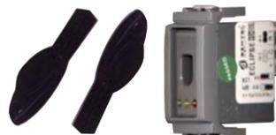
**SB-INM** Inseritore per **chiavi elettroniche** SB-DKC per modulo della scatola 503 (oltre che per la centrale SB-BSD base - 2 nella quale si possono installare un massimo di 4 inseritori, è adatto a tutte le centrali Bentel SB-CNQ SB-CNO), . Tramite **3 led**; rosso, giallo, verde, segnala le funzioni della centrale. Collegamento **bus parallelo**, con cavo SM-2S4, massima lunghezza **400 metri**. Dimensioni H25XL43XP40 mm. € **40,00**
