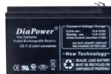
**SS-172** Batteria da **12 V. 7,2 Ah. Accumulatore in tampone**, ermetico a ricombinazione elettrolitica. Composta da piastre di piombo e soluzione solforosa, che per la reazione elettrolitica, si ha la **carica e la scarica**, sono racchiuse in **6 elementi da 2 V.** collegati in serie. Collegamenti esterni tramite **terminali polarizzati** tipo fasto maschi da 5 mm. Contenitore ABS. Forma parallelepipedo. Dimensioni L151XS65XH94 mm. € **25,00**
