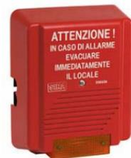
**SS-TSA** Sirena doppia tonalità *autoalimentata lampeggiante antincendio* da interno. Pressione acustica 104 dB. In rispetto della *legge 626/94* è necessaria per avvertire le persone presenti nei locali, del pericolo imminente e di liberare immediatamente i locali in allarme. Alimentazione 220 V. Batteria prevista 12 V 2,1 Ah. Temperatura di funzionamento da - 25° C. a + 55° C. Contenitore di colore rosso. Protezione IP 44. Dimensioni di ingombro L210XH265XP65 mm. Peso Kg. 2,1 € **415,00**
