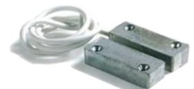
**ST-460** Contatto magnetico corazzato NC in ampolla di vetro sottovuoto. Corrente massima di transito **500 mA. a 30 V. Campo magnetico 25 mm.** Adatto per controllare l'apertura di porte blindate, infissi materiale ferroso. Contenitore in **metallo** forma **rettangolare con fori di fissaggio.** Dimensioni installato L58XH19XS26 mm. € **14,00**
