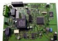
**SE-STM** Scheda **chiamata telefonica** opzionale per centrale d'allarme radio (Elkron) **SE-CWB**. Interfaccia telefonica su rete fissa (PSTN), provvista di connessione per il modulo GSM modello SE-IGM. **16 messaggi a sintesi vocale** preregistrati. 8 numeri telefonici da **28 cifre**, associabili all'evento. Possibilità di **telegestione**, modem integrato. Cuffia di registrazione per l'ascolto dei messaggi vocali In dotazione. € **ND,00**
