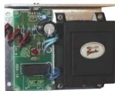
**SV-CB1** Carica batterie stabilizzato, alimentatore. Ingresso 220 V. 50/60 Hz, con fusibile di protezione. uscita 13,8 V cc. 1 A. Segnalazione di erogazione corrente tramite led. Fusibile 160 mA ingresso 220 V. Fusibile 5 A uscita. Montato su staffa di alluminio a L. Adatto come carica batterie, per batterie ermetiche al Piombo. Utile come ricambio per centrali di allarme e alimentazioni supplementari. Dimensioni L117XH92XP56 mm. € **42,00**
