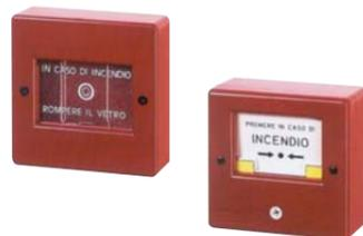
**SS-PRV** Pulsante a rottura vetro. Qualora si verifichi un incendio, per dare l'allarme premere sul vetro (plastica trasparente friabile), fino a provocarne la rottura. Installazione consigliata interno, in modo accessibile e ben visibile. Vetrino di ricambio SS-VPR. Collegamento due o tre fili. Contenitore in plastica rossa. Forma parallelepipedo. Grado di protezione **IP30**. Dimensioni **L90XH90XP5 mm**. Peso Kg. **0,1**. € **70,00**
