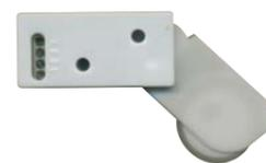
**SE-RCS** Rotello rivelatore di rotazione brevettato. Corrente massima di transito **1 A 250 V**. Il giro della ruota provoca **l'apertura del contatto per circa 50 mS**. (necessita dell'amplificatore conta impulsi SV-MSI). Adatto per rivelare il sollevamento di serrande e tapparelle. Installare in modo che lo **snodo** a molla tocchi la serranda. Contenitore plastico forma rettangolare snodabile. Dimensioni base L82XL22XS19 mm. € **15,00**
