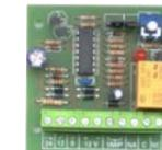
**SS-TIM** Circuito *temporizzatore universale*. Tempo regolabile tramite trimmer da **2" A 3 minuti**. Jumper di programmazione: per il *ritardo di eccitazione*, per *l'eccitazione mo- mentanea o permanente*. Alimentazione **12 V**. Relè **1 scambio 1 A 24 V**. *Compatibile con qualsiasi tipo e marca di centrale di allarme*. Dimensioni **L66XL61XH19 mm**.
