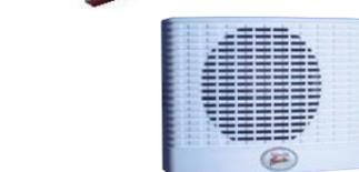
**SS-610** Sirena bitonale con un **diffusore alta resa piezoelettrico.** Pressione acustica **115 dB.** Collegamento con **morsetti polarizzati.** Utile come deterrente di allarme interno. Come **allarme su macchine** operatrici. **Fissaggio a parete,** tramite i fori di fissaggio interni. Alimentazione 12 V. Assorbimento 200 mA. Contenitore in plastica con fori di fissaggio. Dimensioni di ingombro L101XH139XP40 mm. Peso Kg. 0,400. € **18,00**
