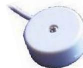
**ST-443** Sonda al **mercurio** adesiva, contatti **NC** immersi in una goccia di **mercurio in ampolla sottovuoto**. Le forti vibrazioni fanno saltare il mercurio, il quale libera i contatti. Corrente **500 mA a 30 V**. Adatta per controllare vetrate, **proteggere dallo scasso strutture dure**. Contenitore tronco cilindrico in **plastica**. Dimensioni **D31XS15 mm**. € **8,50**
