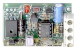
**SE-SER** Centralina per **l'apertura via radio di porte**. La centralina è in grado di comandare qualsiasi **elettroserratura** o elettromagnete alimentato a **12 Vca**. Frequenza di lavoro **433,92 MHz**. Decodifica in **autoapprendimento**, i codici trasmessi dall'integrato **UM 86409** e da emulatori riconosce **4096 diversi codici** di sicurezza. Installazione protetta. **Costruita a norma di legge**. Dimensioni **L73XH40XP20 mm**. € **130,00**
