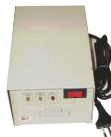
**SS-ST5** Stabilizzatore di tensione 220 V. 50/60 Hz, 500 W. Taglia tutti i picchi di corrente di ingresso da 170 a 270 V. In uscita eroga una tensione stabilizzata di 220 V. Completo di spina, presa e interruttore. Fusibile. Segnalazione tramite tre led, che indicano: presenza di rete, alta, bassa. Utile per apparati elettronici e centrali di allarme dove esistono disturbi di rete. Contenitore da tavolo. Dimensioni L200XL123XH90 mm. € 98,00
