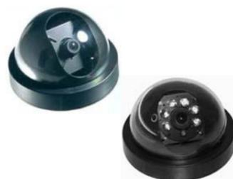
**SM-DCC** Dome camera a colori. Elemento sensibile Sharp 1/4" CCD. Numero di pixel 500HX582V. Risoluzione **380 linee TV**. Sensibilità **0,8 lux** F 1,2. Connettore di alimentazione, BNC uscita video. Contenitore base cilindrica, con cupola in materiale plastico trasparente. Alimentazione 12 V. Assorbimento 120 mA. Dimensioni Ø118XH75 mm. Peso gr. 160. Le rimanenti caratteristiche sono identiche alla SM-MCC. € **150,00**
