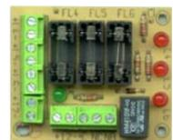
**SS-FAE** Dispositivo per la distribuzione intelligente, di **alimentazioni sotto fusibile**, ad altri componenti esterni. **Due ingressi** di alimentazione da 12 V. Tre **Uscite protette** da rispettivi **fusibili da 2 A**. La **presenza di alimentazione è segnalata da led verde**; la **manca di alimentazione provoca la caduta del relè** di allarme con scambio. **Ogni fusibile se interrotto si illumina il corrispondente led rosso**. Basetta di fissaggio. Dimensioni L66XH53XS15 mm. € **27,00**
