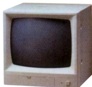
**SM-MBD** Monitor 12" bianco nero da tavolo. Scansione 15.625 Hz. 1000 linee. Banda passante 100 Hz a 10 MHz (3dB). Impedenza d'ingresso 75 Ω. Segnale video composito Sync negativo 0,5+2 Vp-p. Connettori video BNC. Interruttore per l'accensione e i comandi di regolazione sul frontale, protetti da sportellino. Assorbimento 25 W. Alimentazione 220 V. 50/60 Hz. Per impianti TVCC a servizio continuo. Contenitore in materiale plastico. Dimensioni L310XH310XP308 mm. Peso Kg. 9,5. € 200,00
