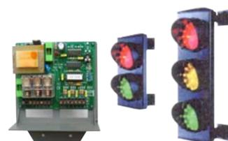
**SB-SDL** Semaforo a 2 luci orientabili, una rossa ed una verde. Lampade a 24 V. 70 W. Diametro delle luci 140 mm. Corpo in materiale plastico autoestinguente. Completo di supporti per il fissaggio. Per le funzioni di semaforo, necessitano due SB-SES, e la centralina di comando, che provvede a temporizzare, lampeggiare, ed invertire. € **145,00**
