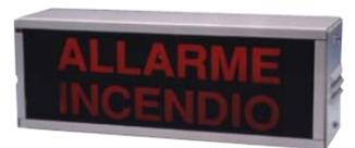
**SF-LBA** Lampada bifacciale ad alta luminosità con segnalatore acustico. Le scritte ALLARME INCENDIO, sono poste sui pannelli in plexiglas intercambiabili di colore rosso. Installazione a bandiera, con le scritte ben visibili, indicanti le vie di fuga. Protetta contro l'inversione di polarità. Contenitore in metallo. Alimentazione **12/24 V**. Assorbimento **30 mA**. Dimensioni **L306XH116XS61 mm**. Peso Kg. **0,5**. € **90,00**
