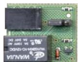
**SV-MR3** Modulo decodifica per **ampliamento canali della ricevente SV-RX3**. Le caratteristiche di **autoapprendimento**, della codifica sono determinate dalla **SV-RX3**. Uscita relé, selezionabile tramite jumper **NC.NA**. Circuito completo di connettore ad innesto. Dimensioni **L23XH26XS14 mm**. € **8,00**
