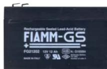
**SF-121** Batteria da **12 V. 12 Ah. Accumulatore in tampone**, ermetico a ricombinazione elettrolitica. Composta da piastre di piombo e soluzione solforosa, che per la reazione elettrolitica, si ha la **carica e la scarica**, sono racchiuse in **6 elementi da 2 V.** collegati in serie. Collegamenti esterni tramite **terminali polarizzati** tipo fasto maschi da 5 mm. Contenitore ABS. Forma parallelepipedo. Dimensioni L151XS98XH94 mm. € **58,00**
