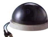
**SM-DCG** Dome camera **bianco e nero.** Numero di pixel 512HX582V. Sensibilità **0,5 lux F 1,2.** Angolo di apertura **92°.** Contenitore base cilindrica, con cupola in materiale plastico trasparente. Dimensioni Ø100XH 72Vmm. Peso Kg. 0,100. Le rimanenti caratteristiche sono identiche alla SM-MBC. € **87,00**
