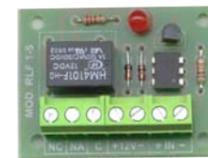
**SS-RLF** Circuito con *relè uno scambio*. Interfaccia di segnale basso, *fotoaccoppiato*, elimina disturbi e sovratensioni. Protetto contro inversione di polarità. Segnalazione trami- te *led*. Alimentazione **12 V**. *Relè 1 scambio 1 A 24 V*. utile per qualsiasi applicazione elettronica dove necessita un *alto isolamento*. Dimensioni **L48XL36XH15 mm**.
