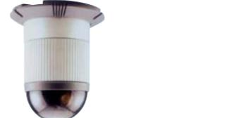
**SM-SDC** Speed Dome camera a **colori**, sistema **rotante da 0 a 350°**. Elemento sensibile Sony Color 1/4". Numero di pixel 752HX582V. Risoluzione **420 linee TV**. Sensibilità **1 lux**. **Iris manuale**. Ottica **3,6 mm**. Impedenza d'uscita 75 Ω 1 Vpp. Contatti striscianti. Comandi tramite consolle SM-CSD. Connettore di alimentazione, BNC **uscita video**. Alimentazione 12 V. Assorb. 2 A. Dimensioni Ø160XH115 mm. Peso Kg. 0,7 € **600,00**
