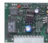
**SS-MRS** Modulo *radioricevente supereterodina* per centrale SS-PM8 e SS-PM5. Connessione ad innesto, su connettore a 10 poli. Apprende i radiocomandi *433 MHz con codifica UM 86409*. Uscita A relé contatto pulito *NA* da 0,5 A/24 Vac. Utile in ambienti disturbati da radiofrequenze e campi magnetici. Per una migliore ricezione installare l'antenna SV-TH4. Alimentazione 24 V. Dimensioni L55XH60XS18 mm. € **82,00**
