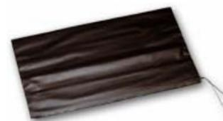
**ST-T83** Tappeto **sensibile** contenitore in **gomma**. Contatti **NA**. Il sistema è composto da **aste d'acciaio flessibili**, sospese da membrane di **gomma**. Posto su un passaggio, come sottotappeto, quando viene **calpestato** si chiude un contatto da **1 A. 75 V**. Utile per azionare aperture di porte automatiche, sistemi di **ripresa televisiva**, sistemi bloccaporte, chiamate telefoniche **antirapina**. Dimensioni **L745XL425XS3 mm**. € **65,00**
