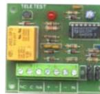
**SS-TSL** Circuito segnalatore di un *cambiamento di stato*, segnala con *impulsi diffe- renziati, quando la tensione si presenta e quando scompare*. Jumper di programmazio- ne impulsi differenziati. Alimentazione **12 V**. Relè **1 scambio 1 A 24 V**. Utile per comanda- re un *cicalino di impianto inserto e disinserito*. Dimensioni **L63XL62XH14 mm**.
