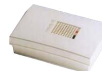
**SR-RGV** Sensore **ambientale per la rottura del vetro a doppia tecnologia**. Analizza **40.000 volte al secondo**, la flessione e la frequenza di **frantumazione del vetro**. Jumper abilitazione **memoria e led**. Portata **9 metri quadri**. Uscita **NC**. Alimentazione **12 V**. Assorbimento **20 mA**. Contenitore in **plastica**. Dimensioni **L71XH49,5XP25 mm**. € **100,00**
