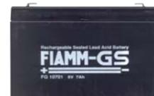
**SF-672** Batteria da **6 V. 7,2 Ah**. **Accumulatore in tampone**, ermetico a ricombinazione elettrolitica. Composta da piastre di piombo e soluzione solforosa, che per la reazione elettrolitica, si ha la **carica e la scarica**, sono racchiuse in **3 elementi da 2 V**. collegati in serie. Collegamenti esterni tramite **terminali polarizzati** tipo fasto maschi da 5 mm. Contenitore ABS. Forma parallelepipedo. Dimensioni L151XS34XH94 mm. € **21,50**
