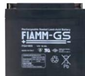
**SF-118** Batteria da **12 V. 18 Ah. Accumulatore in tampone**, ermetico a ricombinazione elettrolitica. Composta da piastre di piombo e soluzione solforosa, che per la reazione elettrolitica, si ha la **carica e la scarica**, sono racchiuse in **6 elementi da 2 V.** collegati in serie. Collegamenti esterni tramite **terminali polarizzati** tipo fasto maschi da 5 mm. Contenitore ABS. Forma parallelepipedo. Dimensioni L181XS76XH167 mm. € **74,50**
