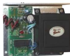
**SS-AS1** Carica batterie stabilizzato, alimentatore. Ingresso 220 V. 50/60 Hz, con fusibile di protezione. uscita 27,6 V cc. 1 A. Segnalazione di erogazione corrente tramite led. Fusibile 315 mA ingresso 220 V. Fusibile 5 A uscita. Montato su staffa di alluminio a L. Adatto come carica batterie. 2 da 12 V. Utile come ricambio per centrali antincendio e alimentazioni supplementari. Dimensioni L144XH108XP65 mm. € **70,00**
