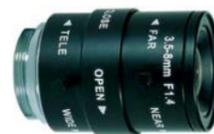
**SM-VTM** Obiettivo **varifocal** filettatura passo CS. Lunghezza focale variabile da **3,5 a 8 mm**. Apertura **F1,4 ~125**. Formato **1/3"**. Angolo di apertura **30,8°**. **Iride manuale**. Adatto per telecamere 1/3 con attacco CS, come le nostre **SM-TB1 SM-TB2 SM-TC1 SM-TC2**. Dimensioni d'ingombro Ø39,5X58,1 mm. Peso Kg. 0,105. € **53,00**
