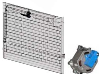
**SV-EUM** Elettrofreno per motoriduttore **SV-MSU**. Corpo in alluminio, completo di viti per il fissaggio. Necessario per lo sblocco di emergenza qualora manchi la corrente elettrica. L'alimentazione necessaria per lo sblocco dell'elettromagnete, è fornita dal motore. Corda e guaina in acciaio, Accessorio consigliato per sblocco esterno, blindino in alluminio pressofuso **SV-BEA**, necessario per l'ancoraggio della corda e guaina € **45,00.**
