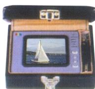
**SM-MLC** Monitor LCD 5,6" a colori. Risoluzione 480 X 234. Ingresso audio 70 V Rms, 10 KΩ. Uscita audio 0,1 W a 8 Ω. Impedenza d'ingresso 75 Ω. Segnale video composito 0,5+1,5 Vp-p. Regolazione livelli tramite comandi sui bordi esterni. Assorbimento 600 mA. Completa di batteria 12 V. e carica batteria 220 V. 50/60 Hz. Contenitore in pelle (valigetta), indispensabile per effettuare prove tecniche sugli impianti TV.CC. Dimensioni L185XH131XP36,5 mm. € 600,00
