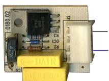
**SV-FEM** Frizione elettronica per motoriduttori 230 V. 50 Hz. Regolazione della forza tramite trimmer. Adatto per motori fino a 700 W di assorbimento. Particolarmente utile per regolare la forza di lavoro dei motori di cancelli; ne può supportare 2 contemporaneamente, regolando l'ingresso del comune di entrambi. Ed è la scheda di ricambio delle centrali **SS-PM8** e **SS-PM5**. Dimensioni L62XH92XS42 mm. Peso 106 gr.
