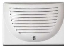
**SS-SPS** Sirena bitonale con un diffusore alta resa piezoelettrico. Pressione acustica 120 dB. Collegamento con morsetti polarizzati. Circuito antimanomissione contro: l'apertura e lo strappo dal muro. Utile come deterrente di allarme interno. Fissaggio a parete. Alimentazione da 9 a 15 Vcc. Nominale 12 Vcc. Assorbimento 350 mA. Contenitore plastica ABS bianca. Dimensioni di ingombro L136XH96XP45 mm. Peso 170 € 15,00
