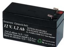
**SS-112** Batteria da **12 V. 1,2 Ah. Accumulatore in tampone**, ermetico a ricombinazione elettrolitica. Composta da piastre di piombo e soluzione solforosa, che per reazione elettrolitica, si ha la **carica e la scarica**, sono racchiuse in **6 elementi da 2 V.** collegati in serie. Collegamenti esterni tramite **terminali polarizzati** tipo fasto maschi da 5 mm. Contenitore ABS. Forma parallelepipedo. Dimensioni L97XH50XP48,5 mm. Peso 528 gr. € **17,00**
