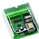
**SV-CAS** Centrale per motore di da sole. Incorpora ricevente radio 433 MHz. Ingresso per anemometro, e pluviometro, in particolare Apprende: sensori **SV-SAF; SV-SAR**. radiocomandi **SV-BF1/BF3/BF6**. Apprendimento delle prestazioni. Servizi: automatico, uomo presente. Alimentazione 220 V. Dimensioni L110XH121XS47 mm. Peso 410 gr.
