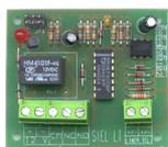
**SS-CLT** Circuito di controllo per **manca di linea telefonica**. L'assenza di linea oltre 10" provoca l'allarme; l'allarme può essere programmato **momentaneo o permanente**. Alimentazione 12 V. assorbimento 2 mA. Relè 1 scambio 1 A 24 V. Compatibile con **qualsiasi tipo e marca di centrale** di allarme. Dimensioni L64XH52XS14 mm. Peso 25 gr. € **21,00**
