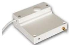
**SC-SAF Switchalarm** completo di conta impulsi. Il sistema è azionato da un **cordino in nylon** di **3 metri** circa. Lo scorrere del cordino oltre i 6 cm provoca l'**allarme**. Uscita relé di allarme programmabile attratto oppure in attrazione, **C.NC.NA**. Alimentazione 12 V. Grado IP30. Temperatura di lavoro  $-25^{\circ}$  a  $+70^{\circ}$ . Dimensioni L100XL100XS40 mm. Peso 220 gr. Le rimanenti caratteristiche sono identiche a **SS-SAL**. € **60,00**
