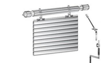
**SV-MS2** Motoriduttore tubolare (Ø 45 mm.) per **TAPPARELLE** e tende da sole. Predisposto per **manovra di soccorso**. Completo di snodo **SV-SNA**, adatto per accessorio **SV-ASG** asta manuale. Potenza **170 W**. Trazione **60 Kg**. L **77 mm**. Dimensioni Ø45XL556X mm. Peso 2,9 Kg. Le rimanenti caratteristiche sono come **SV-MT2** € **215,00**
