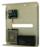
**SC-MCB** Alimentatore Supplementare supervisionato. Per "ELISA24 gsm" e "AMICA 64". Alimentatore e carica batterie al piombo 11.022. Relè interruzione per fine autonomia. Uscita relè sirena. Uscita OC programmabile. Utile per alimentazioni separate. Alloggiamento moduli e schede supplementari. Collegamenti tramite bus. Alimentazione 220 V 50 Hz. **Uscita** 13,8 Vcc. 3,6 A. Dimensioni: L322XH375XP94 mm. Peso 2600 gr. € **310,00**
