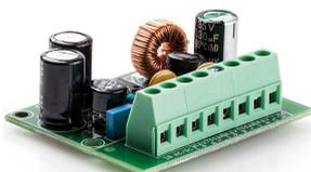
**SV-RTS** Riduttore di tensione stabilizzata 12 Vcc. Led segnalazione in funzione. Ingresso: in corrente continua **da 16 Vdc. a 42 Vdc.**, oppure in corrente alternata **da 17 Vac. a 32 Vac.** 2 Uscite 12 Vdc. e 13,8 Vcc, ciascuna da 0,7 A, o una da 1,4 A, **fusibili** delle uscite **auto-ripristinanti**. Alimentatore telecamere 12 Vcc. Possibilità di uscita per carica batterie da 13,8 Vdc. Dimensioni L50XP20XH85 mm. Peso 40 gr. € **60,00**
