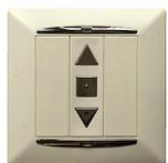
**SV-RPT** Radiocomando da parete 18 Bit, 3 tasti 3 funzioni. con centrali: **SV-CSM; SV-CAS** apre, stop, chiude. Frequenza 433,92 MHz. Codice Random. 2 batterie CR2430 da 3 V. Alimentazione 6 V. Durata prevista della batteria 5 anni. Consumo in trasmissione 25 mA. Contenitore ABS. Dimensioni H80XL80XS15 mm. Peso 71 gr.
