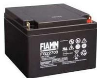
**SF-126** Batteria da **12 V. 27 Ah. Accumulatore in tampone**, ermetico a ricombinazione elettrolitica. Composta da piastre di piombo e soluzione solforosa, che per reazione elettrolitica, si ha la **carica e la scarica**, sono racchiuse in **6 elementi da 2 V.** collegati in serie. Collegamenti esterni tramite **terminali polarizzati** con morsetto a vite. Contenitore ABS. Forma parallelepipedo. Dimensioni L125XH125XP175 mm. Peso 8500 gr. € **150,00**
