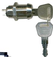
**ST-336** Chiave piatta doppio profilo con deviatore a due posizioni. Contatti C.NC.NA da 3 A, isolamento 220 Volt. Fornita con due chiavi a doppio profilo. Utile per abilitare e disabilitare qualsiasi apparecchiatura. Dimensioni L43XD19 mm. Peso 73 grammi. € 14,00
