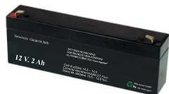
**SS-120** Batteria da **12 V. 2 Ah. Accumulatore in tampone**, ermetico a ricombinazione elettrolitica. Composta da piastre di piombo e soluzione solforosa, che per la reazione elettrolitica, si ha la **carica e la scarica**, sono racchiuse in **6 elementi da 2 V.** collegati in serie. Collegamenti esterni tramite **terminali polarizzati** tipo fasto maschi da 5 mm. Contenitore ABS. Forma parallelepipedo. Dimensioni L178XH34XP60 mm. Peso 865 gr. € **18,00**
