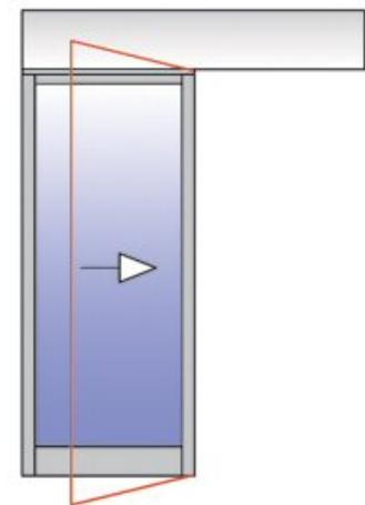
**SV-TAO** Sistema di automazione per **PORTA SCORREVOLE anta singola**. **L.O. 1770 mm**. **P.L. 800 mm**. **L.P. 900 mm**. Le rimanenti caratteristiche sono come **SV-TAS**.
