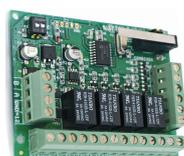
**SC-MER** Modulo di espansione 8 Uscite, di cui 4 Uscite a relé scambio libero 3 A. e 4 uscite O.C. da 100 mA. Per centrali "ELISA24 GSM" e "AMICA 64 plus". Le 8 uscite sono programmabili singolarmente e direttamente dalla centrale. Detti moduli sono indirizzabili tramite dipswitch. Collegamento BUS RS485, con cavo **SM-2S4**. Alimentazione 12 Vcc. Assorbimento 100 mA. Temperatura esercizio 0 - 50°. Dimensioni H85XL65XS16 mm.
