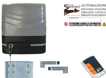
**SV-MCV** Motoriduttore elettromeccanico **CARRERA** per cancello anta **SCORREVOLE OTTO QUINTALI**. Giri motore 1800. Potenza **50 W**. Spazio per alloggiamento centrale e batteria di emergenza. IP44. **Alimentazione 24 Vcc**. Assorbimento medio **3 A**. Ricambio del Kit **SV-KST**. Le rimanenti caratteristiche sono identiche al motore **SV-MSC**.
