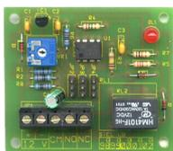
**SS-LBT** Circuito per il **controllo della batteria**; **carica** o scarica. **sensibilità regolabile** tramite trimmer. Jumper di programmazione per la tensione alta o bassa della batteria con l'attivazione del relè. Alimentazione di controllo 13,8 Vcc. Relè 1 scambio 1 A 24 V. Compatibile con **qualsiasi tipo** di batteria. Dimensioni L62XLHXS14 mm. Peso 19 gr.
