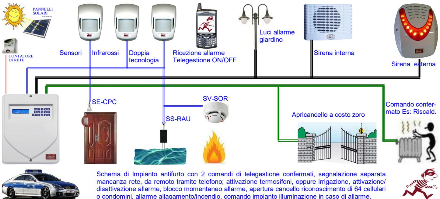
Schema di Impianto antifurto con 2 comandi di telegestione confermati, segnalazione separata mancanza rete, da remoto tramite telefono; attivazione termosifoni, oppure irrigazione, attivazione/disattivazione allarme, blocco momentaneo allarme, apertura cancello riconoscimento di 64 cellulari o condomini, allarme allagamento/incendio, comando impianto illuminazione in caso di allarme.
