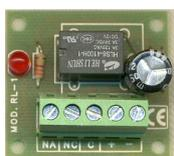
**SS-RLC** Circuito che da un impulso veloce ne produce uno da 1" circa. Interfaccia tra il pulsante del citofono e centrale del cancello. Utile per disaccoppiare circuiti collegati alla stessa linea di alimentazione, quando i fili per lunghi tratti passano vicino a campi induttivi; dove necessita separare i comandi. **Led relè eccitato**. Relè **uno scambio 1 A 24 V**. Alimentazione Impulsiva 12/24 Vacdc. Dimensioni L40XL36XH14 mm. Peso 19 gr. € **16,00**
