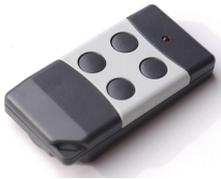
**SV-RLQ** Radiocomando 4 canali. Frequenza 433,92 Mhz. Potenza trasmissione 10 mW. Codifica univoca di sicurezza **Lysa**. Sistema Anticollisione, antiannebbiamento, 281.000 miliardi di combinazioni. Pulsanti: 1 **attivazione**; 2 disattivazione; 3 **parziale 1**. 4 **parziale 2**. Comando della centrale Lysa, e della ricevente **SV-RXV**. Alimentazione batteria 23A 12 V. Contenitore ABS. Dimensioni L67XH34XP10 mm. Peso 0,18 gr.
