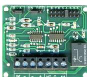
**SV-MSI** Circuito contatore di: **impulsi NC**, impulsi elettrici, controlla la **continuità della linea**. Tramite Jumper si programma: da **1 a 8 impulsi molto brevi**; e l'intervento del relè. Utilità: **analisi dello switchallarm SS-SAL**, nonché di qualsiasi altro sensore, che entro **otto minuti** deve emettere almeno **2 impulsi** per **generare un allarme**. Alimentazione 12 V. Uscita relè 1 scambio 1 A 24 V. Dimensioni L70XH55XS14 mm. Peso 23 gr.
