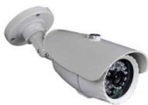
**SM-MKD** Telecamera a colori Day&Nig. Bullet HD Varifocal 2,8-12 HD1/3" Sony SUPER **CMOS 1,3 MP Sensor/1,3MP/960P/P960H ICR, WDR, 3D Sense-UP OSD**. Sensibilità 0,001 Lux. PAL: 25fps@960P(1280x960); 30fps@960P. 42 Led IR x **40 metri** control IRC. Electronic Shutter 1/25s~1/50,000s. Uscita video AHD/CVBS (960H) BNC. Alimentazione 12 V. Plug. Assorbimento IR OFF **300 mA**; IR ON 700 mA. Contenitore da esterno stagno. Protezione **IP66**. Dimensioni L290XØ92XH110 mm. Peso 1600 gr.
