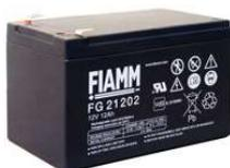
**SF-121** Batteria da 12 V. 12 Ah. **Accumulatore in tampone**, ermetico a ricombinazione elettrolitica. Composta da piastre di piombo e soluzione solforosa, che per la reazione elettrolitica, si ha la **carica e la scarica**, sono racchiuse in **6 elementi da 2 V.** collegati in serie. Collegamenti esterni tramite **terminali polarizzati** tipo fasto maschi da 5 mm. Contenitore ABS. Forma parallelepipedo. Dimensioni L151XH94XP98 mm. Peso 3750 gr.
