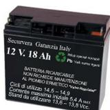
**SS-118** Batteria da **12 V. 17 Ah. Accumulatore in tampone**, ermetico a ricombinazione elettrolitica. Composta da piastre di piombo e soluzione solforosa, che per la reazione elettrolitica, si ha la **carica e la scarica**, sono racchiuse in **6 elementi da 2 V.** collegati in serie. Collegamenti esterni tramite **terminali polarizzati** con morsetto a vite. Contenitore ABS. Forma parallelepipedo. Dimensioni L181XH167XP76 mm. Peso 5650 gr. € **87,00**
