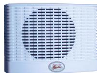
**SS-610** Sirena bitonale con un diffusore alta resa piezoelettrico. Pressione acustica 115 dB. Collegamento con morsetti polarizzati. Utile come deterrente di allarme interno. Come allarme su macchine operatrici. Fissaggio a parete, tramite i fori di fissaggio interni. Alimentazione 12 V. Assorbimento 200 mA. Contenitore in plastica bianco con fori di fissaggio. Dimensioni di ingombro L101XH139XP40 mm. Peso Kg. 0,400 € 18,00
