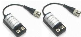
**SH-CBX** Coppia di Balun convertitore segnale video. Ingresso e uscita Videocomposito 75 Ohm. Trasporto segnale convertito con cavo twistato categoria 5 distanza max colori 400 e 600 metri B/N. No alimentazione. Indispensabile per evitare scariche elettriche distruttive, tra telecamera e Video. Dimensioni L51XH17XP30 mm. Peso 35 gr. € **30,00**
