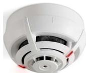
**SV-RTR** Rilevatore **temperatura**, soglia fissa e prefissata. Alimentazione 12/28 Vcc. Assorbimento in allarme 25 mA. Uscita **relè NC**, allarme NA, 1 A 28 Vcc. Compatibile con tutte le centrali di **allarme**. Le rimanenti caratteristiche come **SF-ETD**
