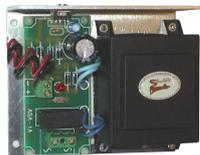
**SV-CB1** Carica batterie stabilizzato, alimentatore. Ingresso 220 V. 50/60 Hz, con fusibile di protezione. uscita 13,8 V cc. 1 A. Segnalazione di erogazione corrente tramite led. Fusibile 160 mA ingresso 220 V. Fusibile 5 A uscita. **Montato su staffa** di alluminio a L. Adatto per batterie ermetiche al Piombo. Utile come ricambio per **centrali di allarme** e alimentazioni supplementari. Dimensioni L140XH110XP68 mm. Peso 721 gr. € 42,00
