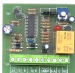
**SS-TIM** Circuito **temporizzatore universale**. Tempo regolabile tramite trimmer **da 2" a 3 minuti**. Jumper di programmazione: per il **ritardo di eccitazione** e diseccitazione; per l'eccitazione **momentanea o permanente**. Compatibile con **qualsiasi tipo e marca** di centrali di allarme. Alimentazione 12/24 Vcc/ca. Relè 1 scambio 1 A 24 V. Assorbimento 50 mA. Completo di basetta di fissaggio. Dimensioni L66XH61XS19 mm. Peso 40 gr.
