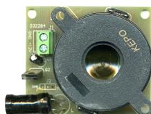
**SS-SPI** Sirena bitonale con un diffusore alta resa piezoelettrico. Pressione acustica 105 dB. Collegamento con morsetti polarizzati. Utile come deterrente di allarme interno. Come allarme su macchine operatrici. Fissaggio interno su apparati, tramite i fori di fissaggio. Alimentazione 12 Vcc. Assorbimento 80 mA. Contenitore in circuito a giorno con fori di fissaggio. Dimensioni di ingombro L53XH46XP31 mm. Peso 45 gr. € 17,00
