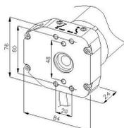
**SV-MCR** Motoriduttore tubolare Ø 58 mm., per **TAPPARELLE** e tende da sole pesanti o grandi dimensioni; per rullo Ø 78 mm. adattatori compresi Ø 70 mm. Trazione **120 Kg**. Potenza **360 W**. L **77 mm**. Le rimanenti caratteristiche sono come **SV-MT1**. € **290,00**
