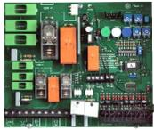
**SV-CBE** Centrale in **autoapprendimento** per cancello a **due ante**. Per motoriduttori a bassa tensione alimentati **12/24 V**. Le rimanenti caratteristiche sono come **SV-CED**
