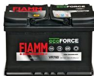
**SF-FCS** Batteria da **12 V. 70 Ah. Accumulatore in tampone**, ermetico a ricombinazione elettrolitica. Composta da piastre di piombo e soluzione solforosa, che per la reazione elettrolitica, si ha la **carica e la scarica**, sono racchiuse in **6 elementi da 2 V.** collegati in serie. Collegamenti esterni tramite **terminali polarizzati** a morsetto vite. Contenitore ABS. Forma parallelepipedo. Dimensioni L350XH166XP174 mm. Peso 22600 gr. € **338,00**
