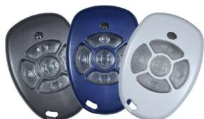
**SB-TP1** Radiocomando 5 canali. Frequenza 433,92 Mhz. Potenza trasmissione 10 mW. Codifica di sicurezza univoca. Sistema stealth, anticollisione. Led trasmissione. Per centrale "**UNISAT**" Funzioni **attivazione disattivazione** allarme, attivazione **parziale 1**, attivazione **parziale 2**, panico sonoro, o telesoccorso. Batteria 3 V. CR2016 Litio. Contenitore ABS, 5 pulsanti. Dimensioni L67XH34XP10 mm. Peso **0,18 gr**.
