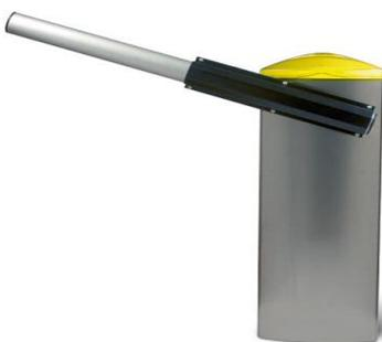
**SV-BIQ** Barriera stradale elettromeccanica. Adatta per **asta (non compresa)** da **2 a 6 metri**. Alimentazione 220 V. 50 Hz. Uso **semi-intensivo condominiale**. Predisposta per: Fotocellule **SV-TEC**. Lampeggiatore **SV-LCB**. Struttura acciaio verniciato; cover **acciaio Inox**. Dimensioni L275XS377XH1090XSIL340 mm. Dimensioni asta 80XL **4 metri**. Le rimanenti caratteristiche sono come **SV-BAQ**, eccetto i cover di **acciaio Inox**.
