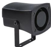
**SA-MSP** Micro sirena piezoelettrica bitonale con staffa di fissaggio in acciaio. Pressione acustica 105 dB. Frequenza da 1500 a 4000 Hz. Utile per interno apparecchiature come allarme, antifurto da interno, su macchine operatrici. Alimentazione 12 Vcc. Assorbimento 200 mA. Contenitore Abs Stagno, non da immersione, con di 15 Cm. di filo polarizzato per il collegamento. Dimensioni L58XH40XP45 mm. Peso 48 gr. € 10,00
