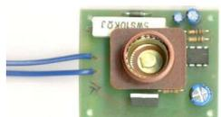
**SV-IPA** Intermittenza elettronica universale completa di portalampe E14. Fori fissaggio ai 4 lati Ø 2 mm. Può supportare sia lampade a filamento che lampade a led veloci. Alimentazione 220 V. 50 Hz. Assorbimento dipende dalla lampada che non deve superare 40 W. Dimensioni d'ingombro L50XH45XS32 mm. Peso 22 gr.
