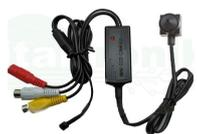
**SM-MPA** Microcamera a colori con **microfono ambientale** separato. Ottica 3,7 mm. Obiettivo PinHole; sensore Sony 1/3" CCD. Risoluzione **420 lineeTV**. Sensibilità: colori **1 lux**; bianco e nero **0,5 lux**. Impedenza d'uscita 75 Ω. Definizione ottimale **8/10 metri**, visibilità infinita. Alimentazione 12 V. Assorbimento 180 mA. Collegamento a connettori BNC RCA. Protezione **IP65**. Dimensioni L10XH10XP10 mm. Peso 27 gr.
