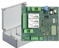
**SS-CES** Centrale semaforica, a due e tre luci. Funzioni manuali tramite: radiocomando, oppure da sensori. Automatico: Tempi programmabili: **rossa**, **gialla**, **verde**. Sistema Interblocco luce **verde** contemporanea su 2 semafori. Alimentazione lampade dei semafori separata da relè liberi 5 A. Uscita **24 V. 400 mA**, per dispositivi. Contenitore ABS. Alimentazione 220 V. 50/60 Hz. Dimensioni H410X190XP20 mm. Peso 1295 gr. € **160,00**
