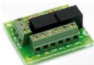
**SV-RLU** Circuito per **2 O.C. da 12 e 24 V**. Due relè **uno scambio 1 A 24 V**. Interfaccia per l'accoppiamento di circuiti aventi **2 uscite negative open collector**. Protetto contro inversione di polarità. Segnalazione attività tramite **2 led**. Utile per applicazioni elettroniche, dove necessita separare i comandi. Dimensioni L40XL36XH14 mm. Peso 45 gr. € **18,00**
