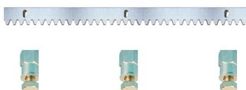
**ST-ACC** Asta a **cremagliera in acciaio** zincata. Modello M4 universale indispensabile per motoriduttori utilizzati per l'automazione di **cancelli scorrevoli**. Dotata di tre fori ovalizzati per la centratura. Completa di tre **bulloni di fissaggio**, con relativi distanziali filettati da un lato a **saldare** dall'altro. Dimensioni L1000XS12XH30 mm. Peso 3,1 Kg.
