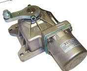
**SV-RMU** Motoriduttore **INTERRATO AUTOBLOCCANTE**, per cancelli ad anta da **0,80 a 2,5 metri**. Motore in alluminio. Potenza motore 280 W. Assorbimento medio 1,4 A. Alimentazione **220 V**. 50/60 Hz. Peso 15 Kg. Le rimanenti caratteristiche sono come **SD-MIU**
