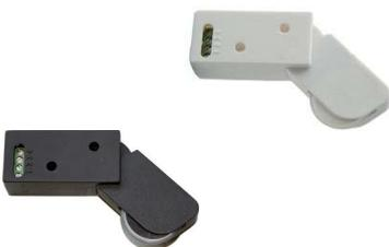
**SE-RCB** Rotello **rilevatore di rotazione** brevettato. Corrente massima di transito **1 A 250 V**. Il giro della ruota provoca l'**apertura del contatto per 50 mS**. (necessita dell'amplificatore conta impulsi **SV-MSI**, Pag. 20). Adatto per rilevare il sollevamento di serrande e tapparelle. Installare in modo che lo **snodo** a molla tocchi la serranda. Contenitore in ABS colore **Bianco**, IP 40. Dimensioni base L82XL22XS19 mm. Peso 22 gr. € **16,00**
