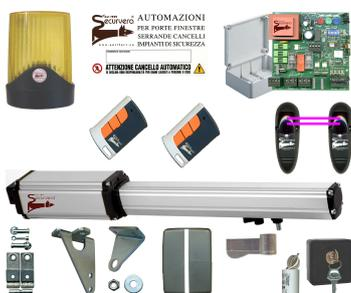
**SV-KC3** Kit automatismo per cancello ad **una singola anta**. Composto da: **1) motore SV-MBS**. Apertura totale del cancello **2 metri**. **1) centrale SV-CED**. **2) radiocomandi SV-ECO**. **1) coppia di fotocellule SV-EVE**. **1) Faro SV-FW7 220 V**. **1) selettore SS-SC2 con 2 chiavi**. **1) Cartello monitor**. Istruzioni di assemblaggio. Alimentazione **220 V**. Le caratteristiche tecniche dei singoli componenti sono riportate nel presente catalistino.
