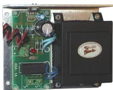
**SS-AS1** Carica batterie stabilizzato, alimentatore. Ingresso 220 V. 50/60 Hz, con fusibile di protezione. uscita 27,6 V cc. 1 A. Segnalazione di erogazione corrente tramite led. Fusibile 315 mA ingresso 220 V. Fusibile 5 A uscita. **Montato su staffa** di alluminio a L. Adatto come carica batterie. 2 da 12 V. Utile come ricambio per **centrali antincendio** e alimentazioni supplementari. Dimensioni L110XH192XP55 mm. Peso 721 gr. € 75,00
