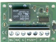
**SS-MIP** Circuito con **relè amplificato ad uno scambio**. Trasforma gli impulsi positivi in passo passo (bistabile), un impulso apre, un impulso chiude. ingresso impulsivo 12 V. diretti, o con resistenza da 1,2 KΩ, utile per uscite Led. Protetto contro inversione di polarità. Segnalazione funzioni tramite **led**. Alimentazione 12 Vcc.. Relè **1 scambio 3 A 24 V**. Fissaggio a giorno, tramite i 4 fori. Dimensioni L49XH25XS17 mm. Peso 17 gr.
