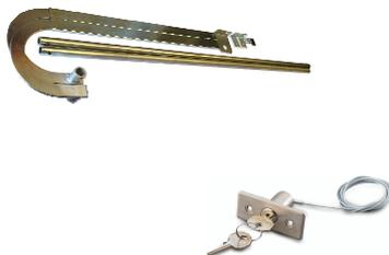
**SV-CBC** Coppia di bracci telescopici **curvi in acciaio** zincato, completi di accessori per il fissaggio. Tubi di trasmissione a **innesto sul motore**, sull'asta di traino forare a misura, bloccare tramite spine in dotazione. Dimensioni guide L750X H40XS10 mm. Dimensioni dell'aste di traino curve L1000XH36XS4 mm. Peso 4,5 Kg.
