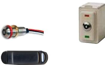
**SA-IMK** Lettore per chiavi **SA-KBD** su modulo **TICINO MAGIC**. **Letto**re di codici di sicurezza **sistema induttivo** inglobato. Led verde, **rosso** per segnalazione stato impianto. Collegamento su morsetti polarizzati. Dimensioni L23XH43XP30 mm. Peso 70 gr.
