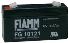
**SF-601** Batteria da 6 V. 1,2 Ah. **Accumulatore in tampone**, ermetico a ricombinazione elettrolitica. Composta da piastre di piombo e soluzione solforosa, che per la reazione elettrolitica, si ha la **carica e la scarica**, sono racchiuse in **3 elementi da 2 V.** collegati in serie. Collegamenti esterni tramite **terminali polarizzati** tipo fasto maschi da 5 mm. Contenitore ABS. Forma parallelepipedo. Dimensioni L97XH51XP25 mm. Peso 315 gr.
