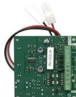
**SV-CSR** Circuito di ricambio per sirene SV-SPF e SV-SPL completo del gruppo Led: led collegamento errato; led allarme lampeggiante, led stato impianto. Alimentazione 12 Vcc. Assorbimento con cono 4 Ω 1,5 A. Dimensioni L72XH72XS30 mm. Peso 44 gr.
