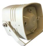
**SV-SET** Sirena bitonale con diffusore esponenziale magnetodinamico alta resa. Pressione acustica 130 dB. Potenza 40 W. Utile come sirena di soccorso, per allarme esterno. Installazione dentro cassonetti di tapparelle, in altri luoghi protetti, in auto fissaggio tramite la staffa orientabile. Alimentazione 12 V. Assorbimento 1,5 A. Contenitore in plastica ABS. Dimensioni di ingombro L105XH80XP90 mm. Peso 0,700 Kg. € 35,00
