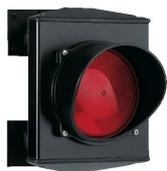
**SS-SLR** Semaforo orientabile a luce **rossa**. Luce prodotta da **25 LED** montati su scheda. Alimentazione **24 Vac/dc**. Assorbimento **150 mA**. Durata dei LED 100.000 ore. Alimentazione 220 V. 50 Hz. Frontalino trasparente pigmentato; Ø 124 mm. Corpo in alluminio e ABS autoestinguente. Grado protezione IP65. Completo di supporti per il fissaggio a parete. Dimensioni H250XL180XP290 mm. Peso 1,7 Kg. € **137,00**
