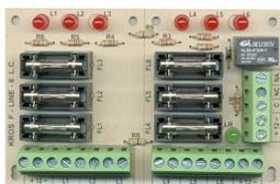
**SS-FAE** Circuito per la distribuzione intelligente di **6 alimentazioni sotto fusibile**, ad altri apparati esterni. 2 gruppi separabili con **2 ingressi** alimentazione; 3 **Uscite** protette per gruppo da **fusibili da 2 A**, segnalate **da led**. Relè di bordo protetto contro l'inversione di polarità. Segnalazione attività tramite Led. Utile per sirene o altro esterno. Scambio relè 1 A 24 V. Basetta di fissaggio. Dimensioni L104XH65XS18 mm. Peso 60 gr.
