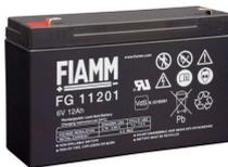
**SF-612** Batteria da 6 V. 12 Ah. **Accumulatore in tampone**, ermetico a ricombinazione elettrolitica. Composta da piastre di piombo e soluzione solforosa, che per la reazione elettrolitica, si ha la **carica e la scarica**, sono racchiuse in **3 elementi da 2 V.** collegati in serie. Collegamenti esterni tramite **terminali polarizzati** tipo fasto maschi da 5 mm. Contenitore ABS. Forma parallelepipedo. Dimensioni L151XH94XP50 mm. Peso 1900 gr.
