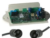
**SV-ADF** Elaboratore: **amplificatore ridondante** completo di **due sonde SV-SIP** una trasmittente, una sonda ricevente. Allineamento e **portata regolabile** da 1 a 6 metri. Indispensabili per: ascensori, bussole antirapina, passaggi controllati, porte automatiche. Relè **contatto Selezionabile** NC o NA 1 A a 24 V. Alimentazione 12/24 Vac/dc. Assorbimento 50 mA. IP X4. Dimensioni S110XH35XP75 mm. Peso 0,400 gr.
