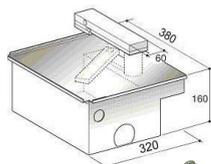
**SV-CFU** Cassa di fondazione in acciaio zincata, dotata di staffe, bulloni, chiave di sblocco, sfera antiatrito, per cancelli ad anta da **0,80 a 2,5 metri**. Peso massimo anta 500 kg. Con foro passacavi, e foro di drenaggio liquidi. Compatibile; Came Frog, Saimatic, Lievore, Almatic, altri. Dimensioni L320XH160XL380 mm Peso 20 Kg.
