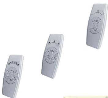
**SV-BF1** Radiocomando 18 Bit 3 tasti 3 funzioni. Utilizzato con centrali: **SV-CSM; SV-CAS** apre, stop, chiude. Frequenza 433,92 MHz. Codice Random, tramite programmatore può essere riprogrammato. Alimentazione Pila 23A 12 V. Consumo in trasmissione 25 mA. Contenitore a tasca da parete, Dimensioni H120XL45XS15 mm. Peso 80 gr.
