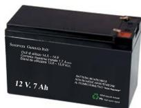
**SS-170** Batteria da **12 V. 7 Ah. Accumulatore in tampone**, ermetico a ricombinazione elettrolitica. Composta da piastre di piombo e soluzione solforosa, che per la reazione elettrolitica, si ha la **carica e la scarica**, sono racchiuse in **6 elementi da 2 V.** collegati in serie. Collegamenti esterni tramite **terminali polarizzati** tipo fasto maschi da 5 mm. Contenitore ABS. Forma parallelepipedo. Dimensioni L151XH65XP94 mm. Peso 1950 gr. € **29,00**
