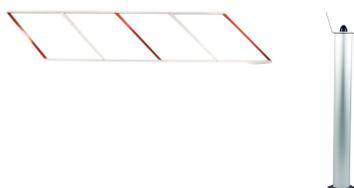
**SV-SMB** Siepe mobile per barriera. Costruita in moduli da 2 metri, montaggio; appesa all'asta. In acciaio verniciato, aste di sbarramento snodate, permettono il piegamento quando l'asta si alza. Dimensioni L370XS370XH1070 mm. Peso per modulo 50 Kg.
