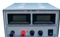
**SS-ASD** Alimentatore stabilizzato. Ingresso 220 V. 50/60 Hz. Tensione di uscita regolabile da 0 a 25 Vcc. 13,8 Vcc. Corrente di uscita 0.1 a 5 A. Stabilità <0,1 con rete ±10 %. Ripple <3 mV. Protezione elettronica. Amperometro e Voltmetro digitale. Contenitore acciaio verniciato da tavolo. Dimensioni L220XP330XH125 mm. Peso 6,5 Kg.
