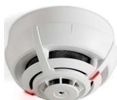
**SV-SOR** Rilevatore di **fumo** ad effetto **Tyndall**. Alimentazione 11/15 Vcc. Assorbimento riposo 50 µA in allarme 25 mA. Uscita a **relè NC** 1 A 28 Vcc. Compatibile con le centrali di **allarme**. Le rimanenti caratteristiche sono identiche a **SF-ESD**
