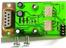
**SF-MS2** Modulo seriale **RS-232** optoisolato; per le centrali **SF-EPU SF-EPD SF-EPQ**. Le centrali sono dotate di tre slot, nei quali può essere inserito questo modulo, con il quale si può collegare la **centrale in rete**, oppure al PC. Contenitore scheda elettronica ad innesto. Alimentazione da centrale tramite connettore. Grado di protezione da centrale. Assorbimento 10 mA. Dimensioni L32XH57XS18 mm. Peso 75 gr.
