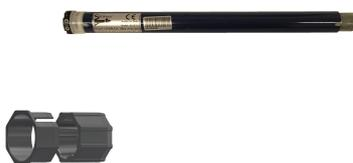
**SV-MTU** Motoriduttore tubolare (Ø 35 mm.), per: **TAPPARELLE** con rullo **ottagonale** da Ø 45 mm. Trazione **13 Nm**. Velocità 16 giri minuto. Fine corsa apertura e chiusura. Potenza **120 W**. Protezione termica 135°. Dotato di accessori e adattatori Ø 44 mm.. Non superare il **peso di trazione 25 kg**. Corpo in acciaio verniciato. Grado di protezione IP 44. Alimentazione 220 V 50 Hz. Dimensioni Ø46XL547X mm. Peso 1650 gr. € **179,00**
