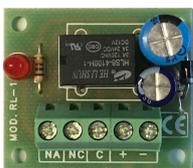
**SV-RLI** Circuito trasforma uno stato ON bistabile in **un impulso** da 1" circa. Interfaccia tra 2 circuiti o due apparati; ad ogni accensione del primo apparato, il 2° riceve un impulso da 1". Uscita relè 1 scambio Libero 1 A a 24 V. Utile all'accensione termosifoni, apertura di porte. Alimentazione 12 Vacdc. Dimensioni L40XL36XH14 mm. Peso 20 gr. € **18,00**
