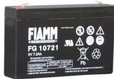
**SF-672** Batteria da 6 V. 7,2 Ah. **Accumulatore in tampone**, ermetico a ricombinazione elettrolitica. Composta da piastre di piombo e soluzione solforosa, che per la reazione elettrolitica, si ha la **carica e la scarica**, sono racchiuse in **3 elementi da 2 V.** collegati in serie. Collegamenti esterni tramite **terminali polarizzati** tipo fasto maschi da 5 mm. Contenitore ABS. Forma parallelepipedo. Dimensioni L151XH94XP34 mm. Peso 1225 gr.
