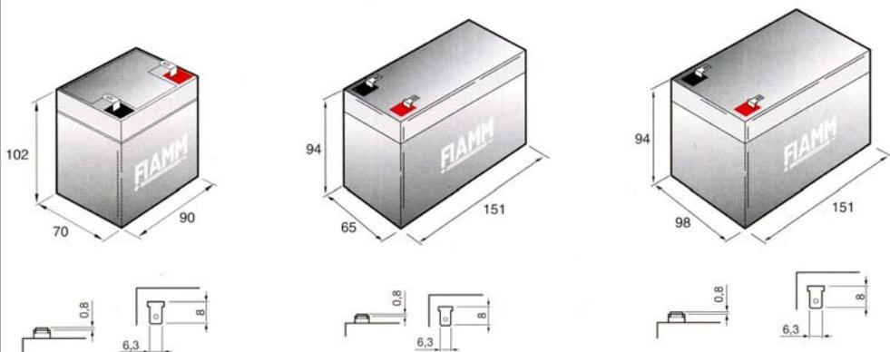
**SF-112** Batteria da 12 V. 1,2 Ah. Accumulatore in tampone, ermetico a ricombinazione elettrolitica. Composta da piastre di piombo e soluzione solforosa, che per la reazione elettrolitica (sistema ermetico regolato da valvola AGM VRLA) si ha la carica e la scarica, sono racchiuse in 6 elementi da 2 V. collegati in serie. Collegamenti esterni tramite terminali polarizzati tipo fasto maschi da 5 mm. Contenitore ABS. Forma parallelepipedo. Dimensioni L97XS48,5XH50,5 mm.
