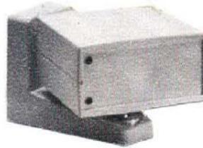
SV-M25 Microonda portata da 0 a 20 m. con LED allarme, disponibile in varie frequenze. Alim. 12 V.c.c. Assorb. 160 mA frequenza da 9,9 a 10,6 GHz. Dispositivo antiaccecamento. Regolazioni sensibilità e ritardo.
