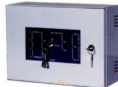
ST-CE5 Centrale di comando DOBBERMAN UNO a 8 zone bilanciate. Una linea temporizzata le altre immediate. Carica batterie elettronico a tampone 2,5 Ah 12 V. Memoria su tutte le linee sensibilità regolabile delle stesse. Temporizzatori interventi regolabili. Possibilità di esclusione a distanza su ogni zona. Relè allarme 6 Ah. Alim. 220 V. c.a. 50/60 Hz. Peso 7 Kg. Dim. 400X300X150 mm.
