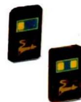
SV-PT1 Mini trasmettitore a codice programmabile, segnalazione luminosa funzioni. Disponibile sia in versione superattiva (306 MHz) con 4096 codici portata 60/80 mt. fino a tre canali, che in versione quarzata (29,7 MHz) con 1024 codici portata 100/400 mt. fino a due canali. Alim. micro batteria a secco 12V. un pulsante per canale. Dim. 60X35X13 mm.
