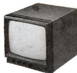
ST-MNT Monitor da 12 pollici per telecamera ST-TP2. Alimentazione 220 V.c.a. impedenza ingresso 75 ohm uscita per altro monitor 75 ohm, contenitore in lamiera verniciato a fuoco, regolazione contrasto e luminosità. Peso Kg. 9,5.
