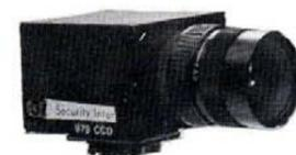
SL-MTV Telecamera CCD allo stato solido 525 linee orizzontali 290 verticali. Alimentazione 12/15 V.d.c. Assorb. 15 mA sensibilità 3 lux. Dimensioni ridottissime 64X50X74 mm. Peso 280 gr. Uscita video 75 ohm. Con staffa. Obiettivo escluso.
