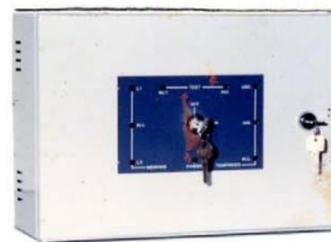
S3-102 Centrale di comando LESSIE UNO a due parzializzatori installazione a parete. Carica batterie elettronico a tampone 1,2 Ah può contenere batteria da 15 Ah 12 V. Temporizzatori controllo impianto regolabili. Memoria d'allarme possibilità di comando a distanza, relè allarme 5 Ah. Alim. 220 V. c.a. 50/60 Hz. Peso 4,8 Kg. Dim. 340X243X149 mm.
