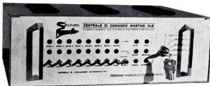
SV-CM4 Centrale di comando MASTINO UNO installazione a Rex contenitore mod. HI-FI. 4 parzializzatori. Può contenere batteria da 15 Ah 12 V. Carica batterie elettronico a tampone 1,8 Ah. Temporizzatori regolabili, impianto giorno, se-
