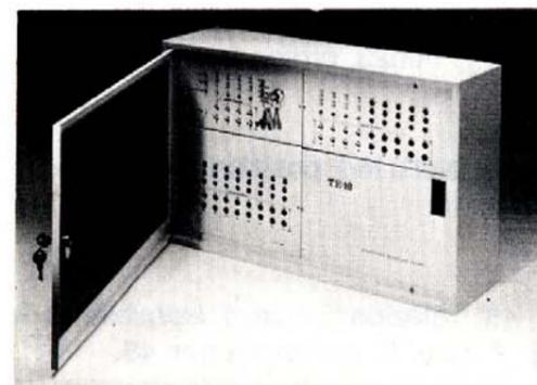
ST-T16 Centrale di comando DOBBERMAN DUE fornita di 16 zone modulari bilanciate per allarme. Espandibile fino a 48 zone temporizzate o dirette su moduli a due zone con ingresso d'inibizione. Carica batterie elettronico a tampone 3 Ah 12 V. con segnalazione batteria efficiente. Circuito modulare temporizzatori interventi regolabili, memorie e test di tutte le funzioni predisposte per segnalazioni a distanza, 2 relè allarme da 8 Ah uno riciclabile l'al-
