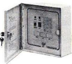
ST-TM5 Chiamata telefonica microcomputers a 2 piste omologato, completo di nastro. Dim. 250X240X90 mm. Alim. 12 V. c.c. Assorb. 200 mA. Batteria indicata 12 V. 2 Ah. Chiamata 5 abbonati su due piste diverse, per antirapina, antincendio, la seconda pista prevale sulla prima, programma numeri, a mezzo tastiera, test. ascolto
