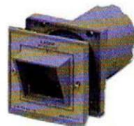
SA-FLI Fotocellula di sicurezza "Laser-Infrarosso", composta da proiettore più ricevitore. Due relè nel ricevitore, per il reciproco controllo di intervento in caso di guasto a uno dei due. Distanza massima di funzionamento in condizioni ottimali 60 mt. Contenitori esterni in nylon rinforzato. Alim. 12 V. c.c. 24 V. c.c. Dispon. da parete, da muro. Adatta anche per protezione passaggi, contapezzi, apriporta.
