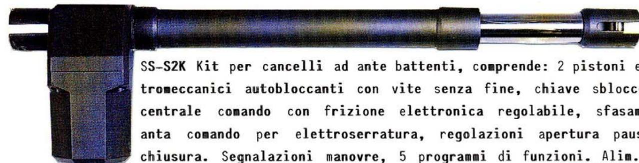
SS-S2K Kit per cancelli ad ante battenti, comprende: 2 pistoni elettromeccanici autobloccanti con vite senza fine, chiave sblocco; 1 centrale comando con frizione elettronica regolabile, sfasamento ante comando per elettroserratura, regolazioni apertura pausa e chiusura. Segnalazioni manovre, 5 programmi di funzioni. Alim. 220 V. 50/60 Hz. Potenza motore 380 W.
