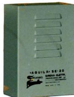
SV-S20 Sirena elettronica autoalimentata AQUILA contenitore in alluminio. Vano batteria da 12 Ah 12 V. Autoprotetta, antisabotaggio ideale per sostituire sirene con 2 conduttori. Alim. 12 V. c.c. Assorb. in allarme 1,4 Ah freq. 950-1800 Hz. Pres. acust. 115 dB a 1m. Pot. usc. 20W. Dim. 30,5X23X15,5 mm. peso 2,750 Kg.
