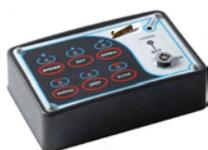
**SV-SEL** Selettore digitale **multifunzione**. Incorpora chiave per il blocco delle funzioni. LED di accesso spento. **Sei pulsanti** di manovra con led che indica l'esecuzione in corso. **Manovre**: solo entrata, solo uscita, entrata ed uscita, **apertura parziale**, apertura totale, **reset centralina** di comando. Utile per gestire i comandi della centralina della porta scorrevole. Collegamento 6 fili. Dimensioni L120XH80XP35 mm. Peso 300 gr.
