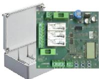
**SS-CES** Centrale semaforica, a due e tre luci. Funzioni manuali tramite: radiocomando, oppure da sensori. Automatico: Tempi **programmabili: rossa, gialla, verde**. Sistema **Interblocco** luce **verde** contemporanea su 2 semafori. Alimentazione lampade dei semafori separata da relè liberi 5 A. **Uscita 24 V. 400 mA**, per dispositivi. Contenitore ABS. Alimentazione 220 V. 50/60 Hz. Dimensioni H410X190XP20 mm. Peso 1295 gr. € **170,00**
