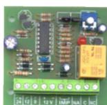
**SS-TIM** Circuito **temporizzatore universale**. Tempo regolabile tramite trimmer **da 2" A 3 minuti**. Jumper di programmazione: per il **ritardo di eccitazione** e diseccitazione; per l'eccitazione **momentanea o permanente**. Compatibile con **qualsiasi tipo e marca di centrale** di allarme. Alimentazione 12/24 Vcc/ca. Relè 1 scambio 1 A 24 V. Assorbimento 50 mA. Completo di basetta di fissaggio. Dimensioni L66XH61XS19 mm. Peso 40 gr.
