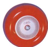
**SF-CBC** Badenia o **campana** a percussione per la segnalazione di **incendio**. Timpano o campana in pressofusione di alluminio, verniciato a fuoco di **colore rosso**, forma tronco cono. Potenza sonora **95 dB**. Il colore e il tipo di suono sono caratteristiche vincolanti per distinguere un **allarme incendio** da altri allarmi. Installazione a parete. Alimentazione **24 V**. Assorbimento **25 mA**. Dimensioni **Ø152XS55 mm**. Peso **820 gr**.
