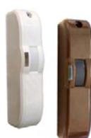
**SV-GFB** Sensore **doppia tecnologia a tenda**. Regolazione della MW; 5 Metri. MW 24 GHz. Angolo di apertura 140°X15° su 2 piani. Immunità RFI 30V/m (da 1 a 5000 Mhz). Protezione alle manomissioni. Installazione a parete indicato sui vani di **porte o finestre**. Alimentazione 12 Vcc. Assorbimento 40 mA. Compensazione Temperatura da -5° a +55°c. Contenitore ABS **Bianco** Dimensioni L110XH31XP26 mm. Peso 85 gr.
