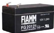
**SF-112** Batteria da 12 V. 1,2 Ah. **Accumulatore in tampone**, ermetico a ricombinazione elettrolitica. Composta da piastre di piombo e soluzione solforosa, che per reazione elettrolitica, si ha la **carica e la scarica**, sono racchiuse in **6 elementi da 2 V**. collegati in serie. Collegamenti esterni tramite **terminali polarizzati** tipo fasto maschi da 5 mm. Contenitore ABS. Forma parallelepipedo. Dimensioni L97XH50XP48,5 mm. Peso 600 gr.
