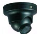
**SM-DCD** Dome camera a colori Day&Night. Elemento sensibile Sony Super Had 1/3" CCD. Ottica 3 mm. Electronic Shutter 1/50-1/100000 sec. Impedenza d'uscita 75 Ω 1 Vpp. Numero di pixel 500HX582V. Risoluzione **540 linee TV**. Sensibilità **0,1 lux**. Connettore di alimentazione. BNC uscita video composito. Contenitore base cilindrica. Alimentazione 12 Vcc. Assorbimento 120 mA. Dimensioni Ø48XH37 mm. Peso 300 gr.
