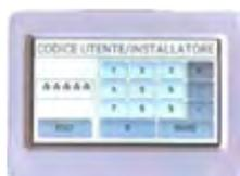
**SV-TUR** Tastiera digitale radio. Frequenza di lavoro 868 MHz. Codifiche **Securvera** Rolling Code. Sistema stealth, anticollisione anti jamming. Costruita per la gestione della centrale "**UNISAT 2**". Funzioni **integralmente ripetute**. Sistema intelligente risparmio batteria. Potenza trasmissione 10 mW. Assorbimento massimo 10 µA. Contenitore ABS. Batteria litio 3,6 V. Dimensioni L120XH190XPS25 mm. Peso con Batteria 195 gr.
