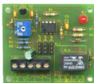
**SS-LBT** Circuito per il **controllo della batteria; carica o scarica**. **sensibilità regolabile** tramite trimmer. Jumper di programmazione per la tensione alta o bassa della batteria con l'attivazione del relè. Alimentazione di controllo 13,8 Vcc. Relè 1 scambio 1 A 24 V. Compatibile con **qualsiasi tipo** di batteria. Dimensioni L62XLHXS14 mm. Peso 19 gr.
