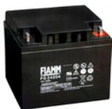
**SF-140** Batteria da **12 V. 42 Ah**. **Accumulatore in tampone**, ermetico a ricombinazione elettrolitica. Composta da piastre di piombo e soluzione solforosa, che per la reazione elettrolitica, si ha la **carica e la scarica**, sono racchiuse in **6 elementi da 2 V**. collegati in serie. Collegamenti esterni tramite **terminali polarizzati** con morsetto a vite. Contenitore ABS. Forma parallelepipedo. Dimensioni L196XH163XP174 mm. Peso 13800 gr. € **200,00**
