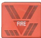
**SF-SIR** Sirena **piezoelettrica da interno**, con scritta lampeggiante **FIRE**. Modulazione elettronica con scelta di tre tipi di suono; **sirena**, **campana**, oppure **beep beep** di preallarme. Il colore e il tipo di suono sono caratteristiche, vincolanti per distinguere un **allarme incendio** da altri allarmi. Installazione a parete. Assorbimento **120 mA**. Alimentazione **24 V**. Contenitore **ABS**. Dimensioni **L110XH100XP30 mm**. Peso **Kg. 0,45**.
