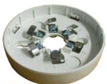
**SV-BRA** Base **universale per rivelatori di fumo** e termici, indirizzati e convenzionali. Predisposta per installazione a parete e con tubi da 16 mm. Rivelatori compatibili **SF-SOD, SF-SOC, SF-SOR, SF-RTA, SF-RTC, SF-RTR, SF-RMA, SF-RMC, SF-RMR**. Contiene **sei morsetti** per l'ancoraggio dei fili dell'impianto, connessione elettrica con il sensore ad incastro. Costruita in ABS. Dimensioni Ø110XH23 mm. Peso 30 gr.
