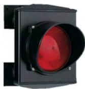
**SS-SLR** Semaforo orientabile a luce **rossa**. Luce prodotta da **25 LED** montati su scheda. Alimentazione **24 Vac/dc**. Assorbimento **150 mA**. Durata dei LED 100.000 ore. Alimentazione 220 V. 50 Hz. Frontalino trasparente pigmentato; Ø 124 mm. Corpo in alluminio e ABS autoestinguente. Grado protezione IP65. Completo di supporti per il fissaggio a parete. Dimensioni H250XL180XP290 mm. Peso 1,7 Kg. € **100,00**
