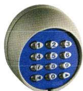
**SN-MTB** Tastiera 10 tasti numerici più 2 di attivazione. Tasti illuminati. Collegamento al decoder **SN-MTD** con due conduttori. Non superare 30 metri di cavo dal decoder. Usare cavo **SM-2S2**. Utile apertura cancelli, porte. Grado di protezione IP 54. Contenitore tronco ovoidale metallo. Dimensioni H80XL70XS30 mm. Peso 115 gr.
