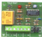
**SS-TSL** Circuito che segnala il **cambiamento di stato**. Jumper di programmazione ingresso: tensione continua o alternata; Contatto NC. o NA. La variazione d'ingresso viene segnalata con **1 impulso per la presenza**, **2 impulsi per l'assenza** di segnale. Alimentazione 12 V. Relè 1 scambio 1 A a 24 V. Utile per comandare un **cicalino** che conferma **impianto inserito e disinserto**. Dimensioni L98XH40XS14 mm. Peso 19 gr.
