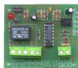
**SS-CLT** Circuito di controllo per **manca di linea telefonica**. L'assenza di linea oltre 10" provoca l'allarme; l'allarme può essere programmato **momentaneo o permanente**. Alimentazione 12 V. assorbimento 2 mA. Relè 1 scambio 1 A 24 V. Compatibile con **qualsiasi tipo e marca di centrale** di allarme. Dimensioni L64XH52XS14 mm. Peso 25 gr. € **22,00**
