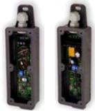
**SV-TRS** Trasmettitore e ricevitore controllo discontinuo, il controllo periodico lo effettua la ricevente ed è così programmabile: escluso oppure da 5 a 15". Qualora il ricevitore non riceve il segnale nel tempo programmato, commuta il relè. Adatto per Coste Meccaniche di Sicurezza. Contenitore in acciaio. Alimentazione 12/24 Vacdc. Grado Protezione IP67. Dimensioni L00XH00XS00 mm. Peso 000 gr.
