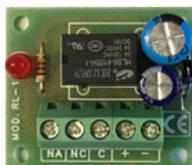
**SV-RLI** Circuito trasforma uno stato ON bistabile in **un impulso** da 1" circa. Interfaccia tra 2 circuiti o due apparati; ad ogni accensione del primo apparato, il 2° riceve un impulso da 1". Uscita relè 1 scambio Libero 1 A a 24 V. Utile all'accensione termosifoni, apertura di porte. Alimentazione 12 Vacdc. Dimensioni L40XL36XH14 mm. Peso 20 gr. € **20,00**
