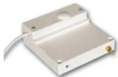
**SC-SAF** Switchalarm completo di conta impulsi. Il sistema è azionato da un **cordino in nylon** di **3 metri** circa. Lo scorrere del cordino oltre i 6 cm provoca **l'allarme**. Uscita relé di allarme programmabile attratto oppure in attrazione, **C.NC.NA**. Alimentazione 12 V. Grado IP30. Temperatura di lavoro  $-25^{\circ}$  a  $+70^{\circ}$ . Dimensioni L100XL100XS40 mm. Peso 220 gr. Le rimanenti caratteristiche sono identiche a **SS-SAL**. € **65,00**
