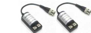
**SH-CBX** Coppia di Balun convertitore segnale video. Ingresso e uscita Videocomposito 75 Ohm. Trasporto segnale convertito con cavo twistato categoria 5 distanza max colori 400 e 600 metri B/N. No alimentazione. Indispensabile per evitare scariche elettriche distruttive, tra telecamera e Video. Dimensioni L51XH17XP30 mm. Peso 35 gr. € **30,00**
