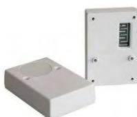
**SS-WA2** Rivelatore presenza acqua, oppure liquidi conduttivi. 4 punte sensoriali dorate. Sensibilità regolabile tramite trimmer. Uscita relè di allarme, tramite centralina può azionare idrovore, chiamata telefonica. Utile per le perdite di acqua, sotto il lavello, per il bagno, perdita di liquidi conduttivi, come vino e altro. Alimentazione 12 V. Assorbimento 15 mA. Contenitore in ABS. Dimensioni L70XH100XP29 mm. Peso 10 gr.
