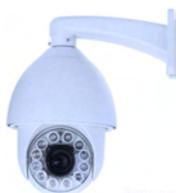
**SM-AUG** Speed Dome camera a colori Day&Nig da esterno FULL HD. Sony 2.1 MP Sensor/1920P/1080H ICR, WDR, 3D NR Sense-UP OSD. Zoom ottico 30X 4.7-141 mm. Electronic Shutter 1/50s-1/10000s. AHD PAL/NTSC BNC. Multicontrollo PELCO-D, PELCO-P,RS485; 256 preset, 8 tour programmabili, su 4 Gruppi. Led IR da 110 metri filtro IRC. Alimentatore compreso 220 V. 50/60 Hz. Uscita 12 V. 5 A. Contenitore da esterno. Protezione IP 66. Dimensioni L220XH365XØ300 mm. Peso 5000 gr.
