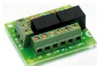
**SV-RLU** Circuito per **2 O.C. da 12 e 24 V**. Due relè **uno scambio 1 A 24 V**. Interfaccia per l'accoppiamento di circuiti aventi **2 uscite negative open collector**. Protetto contro inversione di polarità. Segnalazione attività tramite **2 led**. Utile per applicazioni elettroniche, dove necessita separare i comandi. Dimensioni L40XL36XH14 mm. Peso 45 gr. € **18,00**
