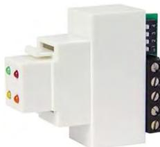
**SC-LSN** Lettore seriale **Nero** per **chiave di prossimità** su modulo LAN Universale. Per le centrali **Combivox**. La programmazione e la memorizzazione, **della singola chiave SC-CEP** con oltre **4 miliardi di combinazioni**; avviene dalla relativa **centrale**. Segnalazione delle funzioni tramite 4 led verde rosso giallo arancio. Collegamento BUS, con cavo **SM-2S4** massimo **400 metri**. Dimensioni H25XL43XP40 mm. Peso 22 gr.
