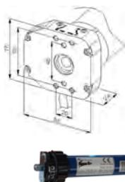
**SV-MCR** Motoriduttore tubolare Ø 58 mm., per **TAPPARELLE** e tende da sole pesanti o grandi dimensioni; per rullo Ø 78 mm. adattatori compresi Ø 70 mm. Trazione **120 Kg**. Potenza **360 W**. L **77 mm**. Le rimanenti caratteristiche sono come **SV-MT1**. € 310,00
