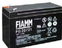
**SF-172** Batteria da 12 V. 7,2 Ah. **Accumulatore in tampone**, ermetico a ricombinazione elettrolitica. Composta da piastre di piombo e soluzione solforosa, che per reazione elettrolitica, si ha la **carica e la scarica**, sono racchiuse in **6 elementi da 2 V**. collegati in serie. Collegamenti esterni tramite **terminali polarizzati** tipo fasto maschi da 5 mm. Contenitore ABS. Forma parallelepipedo. Dimensioni L151XH94XP65 mm. Peso 2450 gr.
