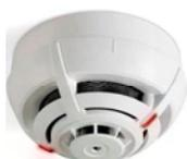
**SV-RFT** Rilevatore **multicriterio** (doppia tecnologia) **fumo e calore 62° convenzionale**. Compatibile con tutte le centrali **antincendio convenzionali**, che rilevano l'allarme per assorbimento; riposo 50 µA allarme 25 mA. Le rimanenti caratteristiche come **SF-ERM**
