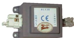
**SS-ACB** Carica batterie stabilizzato, alimentatore. Ingresso 220 V 50/60 Hz, con fusibile di protezione. Uscita 13,8 Vcc. 0,4 A. Adatto come carica batterie, per batterie ermetiche al Piombo utile come **ricambio per centrali di allarme**, oppure come supplementare. **Inglabato nel contenitore**, che è di materiale plastico antiurto. Dimensioni L95XH48XP55 mm.
