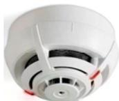
**SV-RTC** Rilevatore di **temperatura convenzionale**, soglia fissa 62°, o prefissata. Compatibile con le centrali **antincendio convenzionali**, che rilevano l'allarme per assorbimento; riposo 50 µA allarme 25 mA. Le rimanenti caratteristiche sono come **SF-ETD**
