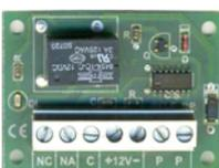
**SS-MIP** Circuito con **relè amplificato ad uno scambio**. Trasforma gli impulsi positivi in passo passo (bistabile), un impulso apre, un impulso chiude. ingresso impulsivo 12 V. diretti, o con resistenza da 1,2 KΩ, utile per uscite Led. Protetto contro inversione di polarità. Segnalazione funzioni tramite **led**. Alimentazione 12 Vcc.. Relè **1 scambio 3 A 24 V**. Fissaggio a giorno, tramite i 4 fori. Dimensioni L49XH25XS17 mm. Peso 17 gr.
