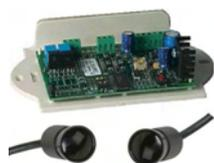
**SV-ADF** Elaboratore: **amplificatore ridondante** completo di **due sonde SV-SIP** una trasmittente, una sonda ricevente. Allineamento e **portata regolabile** da 1 a 6 metri. Indispensabili per: ascensori, bussole antirapina, passaggi controllati, porte automatiche. Relè **contatto Selezionabile** NC o NA 1 A a 24 V. Alimentazione 12/24 Vac/dc. Assorbimento 50 mA. IP X4. Dimensioni S110XH35XP75 mm. Peso 0,400 gr. € **135,00**
