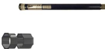
**SV-MTU** Motoriduttore tubolare (Ø 35 mm.), per: **TAPPARELLE** con rullo **ottagonale** da Ø 45 mm. Trazione **13 Nm**. Velocità 16 giri minuto. Fine corsa apertura e chiusura. Potenza **120 W**. Protezione termica 135°. Dotato di accessori e adattatori Ø 44 mm.. Non superare il **peso di trazione 25 kg**. Corpo in acciaio verniciato. Grado di protezione IP 44. Alimentazione 220 V 50 Hz. Dimensioni Ø46XL547X mm. Peso 1650 gr. € 180,00
