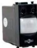
**ST-AIM** Rilevatore **infrarosso accendiluci**. Crepuscolare luminosità regolabile giorno/notte. Portata **7 metri**. Lampada accesa tempo regolabile da 8" a 3,30'. Carico **max 1 KW**. Angolo di rilevamento 120°. **Led** segnalazione movimento. Tempo di stabilizzazione 30". Alimentazione 220 V. 50/60 Hz. Assorbimento 1 W. Temperatura di lavoro da -10° a 40°C. Contenitore ABS IP 40. Dimensioni L48,6XH22XS51,6 mm. Peso 75 gr.
