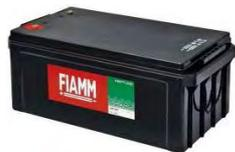
**SF-FDC** Batteria da **12 V. 200 Ah**. **Accumulatore in tampone**, ermetico a ricombinazione elettrolitica. Composta da piastre di piombo e soluzione solforosa, che per la reazione elettrolitica, si ha la **carica e la scarica**, sono racchiuse in **6 elementi da 2 V**. collegati in serie. Collegamenti esterni tramite **terminali polarizzati** a morsetto vite. Contenitore ABS. Forma parallelepipedo. Dimensioni L520XH260XP204 mm. Peso 68000 gr. € **910,00**
