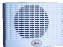
**SS-610** Sirena bitonale con un diffusore alta resa piezoelettrico. Pressione acustica 115 dB. Collegamento con morsetti polarizzati. Utile come deterrente di allarme interno. Come allarme su macchine operatrici. Fissaggio a parete, tramite i fori di fissaggio interni. Alimentazione 12 V. Assorbimento 200 mA. Contenitore in plastica bianco con fori di fissaggio. Dimensioni di ingombro L101XH139XP40 mm. Peso Kg. 0,400 € 20,00
