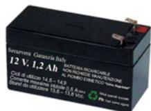
**SS-112** Batteria da **12 V. 1,2 Ah**. **Accumulatore in tampone**, ermetico a ricombinazione elettrolitica. Composta da piastre di piombo e soluzione solforosa, che per reazione elettrolitica, si ha la **carica e la scarica**, sono racchiuse in **6 elementi da 2 V**. collegati in serie. Collegamenti esterni tramite **terminali polarizzati** tipo fasto maschi da 5 mm. Contenitore ABS. Forma parallelepipedo. Dimensioni L97XH50XP48,5 mm. Peso 528 gr. € **19,00**
