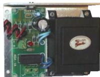
**SV-CB1** Carica batterie stabilizzato, alimentatore. Ingresso 220 V. 50/60 Hz, con fusibile di protezione. uscita 13,8 V cc. 1 A. Segnalazione di erogazione corrente tramite led. Fusibile 160 mA ingresso 220 V. Fusibile 5 A uscita. **Montato su staffa** di alluminio a L. Adatto per batterie ermetiche al Piombo. Utile come ricambio per **centrali di allarme** e alimentazioni supplementari. Dimensioni L140XH110XP68 mm. Peso 721 gr.
