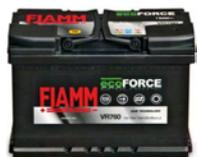
**SF-FCS** Batteria da **12 V. 70 Ah**. **Accumulatore in tampone**, ermetico a ricombinazione elettrolitica. Composta da piastre di piombo e soluzione solforosa, che per la reazione elettrolitica, si ha la **carica e la scarica**, sono racchiuse in **6 elementi da 2 V**. collegati in serie. Collegamenti esterni tramite **terminali polarizzati** a morsetto vite. Contenitore ABS. Forma parallelepipedo. Dimensioni L350XH166XP174 mm. Peso 22600 gr. € **340,00**
