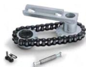
**SV-ACG** Kit Leva ingranaggio, catena per ottenere apertura fino a **180°**, per Motore Interrato Under **SV-UMI** Sistema di facile installazione la catena a una falsa maglia per rendere semplice l'inserimento; il sistema va montato direttamente sull'asse del motore tramite la catena di traino fa ruotare la leva che muove il cancello.
