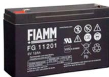
**SF-612** Batteria da 6 V. 12 Ah. **Accumulatore in tampone**, ermetico a ricombinazione elettrolitica. Composta da piastre di piombo e soluzione solforosa, che per la reazione elettrolitica, si ha la **carica e la scarica**, sono racchiuse in **3 elementi da 2 V**. collegati in serie. Collegamenti esterni tramite **terminali polarizzati** tipo fasto maschi da 5 mm. Contenitore ABS. Forma parallelepipedo. Dimensioni L151XH94XP50 mm. Peso 1900 gr.
