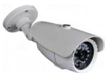
**SM-MKD** Telecamera a colori Day&Nig. Bullet HD Varifocal 2,8-12 HD1/3" Sony SUPER CMOS 1,3 MP Sensor/1,3MP/960/P960H ICR, WDR, 3D Sense-UP OSD. Sensibilità 0,001 Lux. PAL: 25fps@960P(1280x960); 30fps@960P. 42 Led IR x 40 metri control IRC. Electronic Shutter 1/25s-1/50,000s. Uscita video AHD/CVBS (960H) BNC. Alimentazione 12 V. Plug. Assorbimento IR OFF 300 mA; IR ON 700 mA. Contenitore da esterno stagno. Protezione IP66. Dimensioni L290XØ92XH110 mm. Peso 1600 gr.
