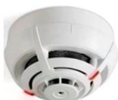
**SV-RFA** Rilevatore di **fumo** ad effetto **Tyndall convenzionale**. Compatibile a tutte le centrali convenzionali, che rilevano l'allarme per assorbimento; sensore in riposo 50 µA in allarme 25 mA. Le rimanenti caratteristiche sono identiche al **SF-ESD**
