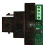
**SV-TSG** Lettore (su modulo LAN 503 di qualsiasi marca e tipo) della **chiave di prossimità SV-CEP**, per il comando remoto della centrale **SV-C8P**. La quale supporta **massimo 3 lettori** compresa la tastiera **SV-TSP**. Segnalazione delle funzioni tramite **led**. Collegamento seriale con cavo **SM-2S4** lunghezza massima **400 metri**. Contenitore ABS incastonante presa LAN. Dimensioni d'ingombro H45XL18XP56 mm. **Peso 22 gr.**
