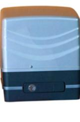
**SV-RMS** Kit **ricambio** per cancello **SCORREVOLE 6 QUINTALI**. Composto da: **1** motore **SIMPLY SV-MRS** con **SBLOCCO** a chiave. Incorpora **1** centrale **SV-CES** con frizione elettronica e ricevente radio 433,92 Mhz, codici e tempi in autoapprendimento. **1** radiocomando Rollig Code **SV-TRC**. Cartello monitor. Istruzioni. **Alimentazione 220 V.** 50 Hz.
