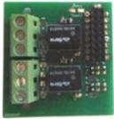
**SF-UPR** Kit 2 relè separati contatti liberi C.NC.NA da 1 a 24 V. Per allarme e guasto. Inserimento a connettore da montare all'interno del pannello **SF-RIP**. Alimentazione 24 Vcc da connettore. Assorbimento 20 mA. Temperatura di lavoro -10°C a +70°C. Contenitore Circuito a giorno. Dimensioni L46XH43XP18 mm. Peso 40 gr.
