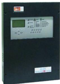
**SF-EPD** Centrale antincendio **indirizzata a 16 bit, due loop 254 indirizzi**. 126 zone indipendenti. Può contenere 2 batterie 12 Volt 18 Ah. Dimensioni L410XH510XP90 mm. Peso Kg. 11. Le rimanenti caratteristiche sono identiche alla **SF-EPU** € **1.890,00**
