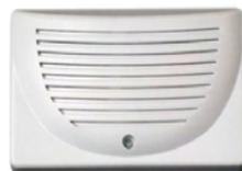
**SS-SPS** Sirena bitonale con un diffusore alta resa piezoelettrico. Pressione acustica 120 dB. Collegamento con morsetti polarizzati. Circuito antimanomissione contro: l'apertura e lo strappo dal muro. Utile come deterrente di allarme interno. Fissaggio a parete. Alimentazione da 9 a 15 Vcc. Nominale 12 Vcc. Assorbimento 350 mA. Contenitore plastica ABS bianca. Dimensioni di ingombro L136XH96XP45 mm. Peso 170 € 18,00
