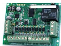
**SC-MEA** Modulo di espansione **8 zone**, per centrali "**ELISA24 GSM**" **SC-CEV** "**AMICA 64 plus**". Le 8 zone possono essere programmate come: **NC, NA**, bilanciate e doppio bilanciamento. Le **2 uscite** 1 è open collector, l'altra a relé libero, **c.NC.NA**. Detti moduli **sono indirizzabili** tramite dipswitch. Le zone e le uscite, si programmano dalla centrale, Collegamento BUS RS485, con cavo **SM-2S4**. Dimensioni H22XL120XP71 mm.
