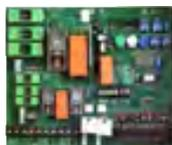
**SV-ECB** Centrale in **autoapprendimento** per cancello a **due ante**. Per motoriduttori a bassa tensione alimentati **12/24 V**. Le rimanenti caratteristiche sono come **SV-CED**
