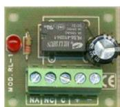
**SS-RLC** Circuito che da un impulso veloce ne produce uno da 1" circa. Interfaccia tra il pulsante del citofono e centrale del cancello. Utile per disaccoppiare circuiti collegati alla stessa linea di alimentazione, quando i fili per lunghi tratti passano vicino a campi induttivi; dove necessita separare i comandi. **Led relè eccitato**. Relè **uno scambio 1 A 24 V**. Alimentazione Impulsiva 12/24 Vacdc. Dimensioni L40XL36XH14 mm. Peso 19 gr. € **18,00**
