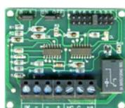
**SV-MSI** Circuito contatore di: **impulsi NC**, impulsi elettrici, controlla la **continuità della linea**. Tramite Jumper si programma: da **1 a 8 impulsi molto brevi**; e l'intervento del relè. Utilità: **analisi dello switchalarm SS-SAL**, nonché di qualsiasi altro sensore, che entro **otto minuti** deve emettere almeno **2 impulsi per generare un allarme**. Alimentazione 12 V. Uscita relè 1 scambio 1 A 24 V. Dimensioni L70XH55XS14 mm. Peso 23 gr.
