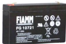
**SF-672** Batteria da 6 V. 7,2 Ah. **Accumulatore in tampone**, ermetico a ricombinazione elettrolitica. Composta da piastre di piombo e soluzione solforosa, che per la reazione elettrolitica, si ha la **carica e la scarica**, sono racchiuse in **3 elementi da 2 V**. collegati in serie. Collegamenti esterni tramite **terminali polarizzati** tipo fasto maschi da 5 mm. Contenitore ABS. Forma parallelepipedo. Dimensioni L151XH94XP34 mm. Peso 1225 gr.
