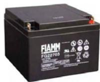
**SF-126** Batteria da **12 V. 27 Ah**. **Accumulatore in tampone**, ermetico a ricombinazione elettrolitica. Composta da piastre di piombo e soluzione solforosa, che per reazione elettrolitica, si ha la **carica e la scarica**, sono racchiuse in **6 elementi da 2 V**. collegati in serie. Collegamenti esterni tramite **terminali polarizzati** con morsetto a vite. Contenitore ABS. Forma parallelepipedo. Dimensioni L125XH125XP175 mm. Peso 8500 gr. € **160,00**
