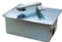
**SV-UMB** Motoriduttore **INTERRATO** con **SBLOCCO** di emergenza **chiave** dedicata compresa, per cancelli ad anta da **0,80 a 2,5 metri**. Assorbimento **2,7 A**. Potenza motore 60 W. Alimentazione **24 Vcc**. Le rimanenti caratteristiche sono come **SD-MIU**
