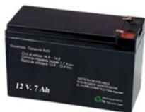
**SS-170** Batteria da **12 V. 7 Ah**. **Accumulatore in tampone**, ermetico a ricombinazione elettrolitica. Composta da piastre di piombo e soluzione solforosa, che per la reazione elettrolitica, si ha la **carica e la scarica**, sono racchiuse in **6 elementi da 2 V**. collegati in serie. Collegamenti esterni tramite **terminali polarizzati** tipo fasto maschi da 5 mm. Contenitore ABS. Forma parallelepipedo. Dimensioni L151XH65XP94 mm. Peso 1950 gr. € **33,00**
