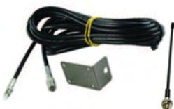
**SC-PAC** Antenna GSM prolunga di cinque metri. Composta da staffa di fissaggio dipolo freddo, **antenna accordata per GSM** a stilo, polo caldo. **5 metri circa di cavo** schermato a lunghezza accordata. Sia le dimensioni del cavo, che dell'antenna non possono essere variate. Adatto nei casi in cui la ricezione ambientale è scarsa. Prima del fissaggio definitivo vi consigliamo di fare le prove di ricezione per trovare il punto più ricettivo.
