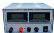
**SS-ASD** Alimentatore stabilizzato. Ingresso 220 V. 50/60 Hz. Tensione di uscita regolabile da 0 a 25 Vcc. 13,8 Vcc. Corrente di uscita 0.1 a 5 A. Stabilità <0,1 con rete  $\pm 10\%$ . Ripple <3 mV. Protezione elettronica. Amperometro e Voltmetro digitale. Contenitore acciaio verniciato da tavolo. Dimensioni L220XP330XH125 mm. Peso 6,5 Kg.
