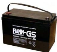
**SF-FCA** Batteria da **12 V. 100 Ah**. **Accumulatore in tampone**, ermetico a ricombinazione elettrolitica. Composta da piastre di piombo e soluzione solforosa, che per la reazione elettrolitica, si ha la **carica e la scarica**, sono racchiuse in **6 elementi da 2 V**. collegati in serie. Collegamenti esterni tramite **terminali polarizzati** a morsetto vite. Contenitore ABS. Forma parallelepipedo. Dimensioni L329XH172XP214 mm. Peso 32800 gr. € **415,00**
