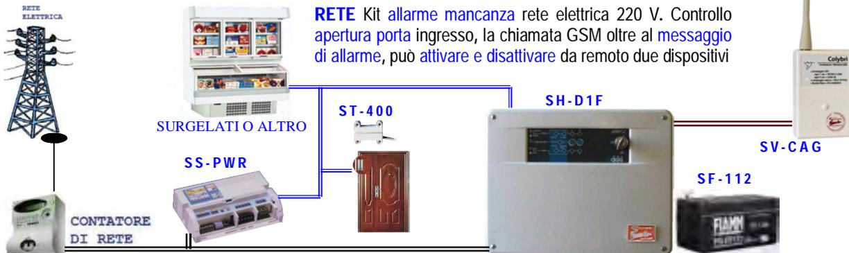
**RETE** Kit **allarme mancanza** rete elettrica 220 V. Controllo **apertura porta** ingresso, la chiamata GSM oltre al **messaggio di allarme**, può **attivare e disattivare** da remoto due dispositivi
