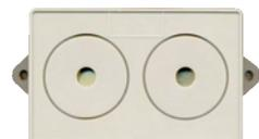
**ST-SB2** Sirena bitonale con due diffusori piezoelettrici. Pressione acustica 100 dB. Utile come deterrente di allarme interno. Come allarme su macchine operatrici. Fissaggio a parete, oppure sul pannello, tramite alette di fissaggio. Alimentazione 12 V. Assorbimento 100 mA. Contenitore in plastica con alette di fissaggio, distanza tra i fori 92 mm. Dimensioni di ingombro L84XH54XS32 mm. Peso Kg. 0,100. € 20,00
