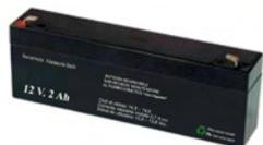
**SS-120** Batteria da **12 V. 2 Ah**. **Accumulatore in tampone**, ermetico a ricombinazione elettrolitica. Composta da piastre di piombo e soluzione solforosa, che per la reazione elettrolitica, si ha la **carica e la scarica**, sono racchiuse in **6 elementi da 2 V**. collegati in serie. Collegamenti esterni tramite **terminali polarizzati** tipo fasto maschi da 5 mm. Contenitore ABS. Forma parallelepipedo. Dimensioni L178XH34XP60 mm. Peso 865 gr. € **20,00**
