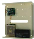
**SC-MCB** Alimentatore Supplementare supervisionato. Per **"ELISA24 gsm"** e **"AMICA 64"**. Alimentatore e carica batterie al piombo 11.022. Relè interruzione per fine autonomia. Uscita relè sirena. Uscita OC programmabile. Utile per alimentazioni separate. Alloggiamento moduli e schede supplementari. Collegamenti tramite bus. Alimentazione 220 V 50 Hz. **Uscita** 13,8 Vcc. 3,6 A. Dimensioni: L322XH375XP94 mm. Peso 2600 gr. € **335,00**
