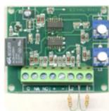
**SS-TWN** Circuito **amplificatore** per **sensori inerziali ST-IN4**, o qualsiasi altro sensore che emette **impulsi veloci** da 3 a 30 millisecondi. **Due linee bilanciate**, con **regolazione separata** della sensibilità. Uscita relè 1 A 220V. Alimentazione 12 V. Analizza ed amplifica segnali veloci **NA**, supporta **massimo 5 sensori**, ad una distanza di 200 metri. Completo di basetta di fissaggio. Dimensioni L70XH55XS14 mm. Peso 25 gr.
